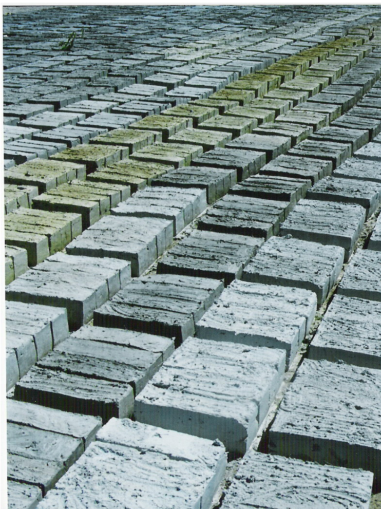
Foto 17 – Fabricação(secagem) dos tijolos de adobe da casa de adobe do Ação Kalunga em limoeiro Crédito: Jônatas Barreto
