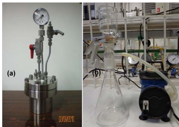
Figura 16: Aparato utilizado na análise de estabilidade oxidativa de diesel: (a) reator para envelhecimento; (b) sistema de filtração.
