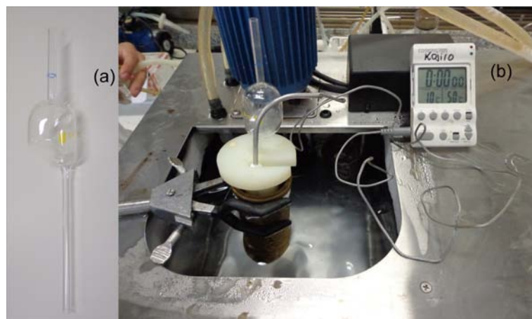
Figura 18: Sistema de análise de entupimento de filtro a frio: (a) frasco de teste; (b) aparato para a análise do ponto de entupimento.
