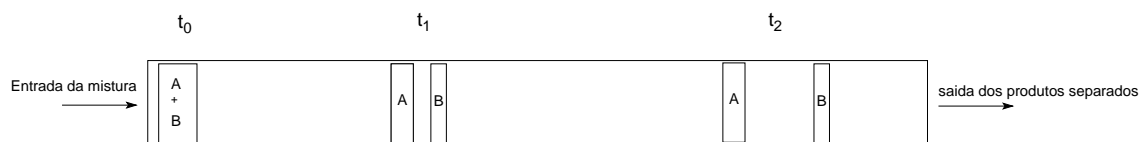
Figura 23: Princípio de separação de uma mistura de A e B em uma coluna cromatográfica.
