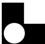
**Figura 1:** Desenho esquemático da peça de latão confeccionada para auxiliar no corte dos espécimes.
