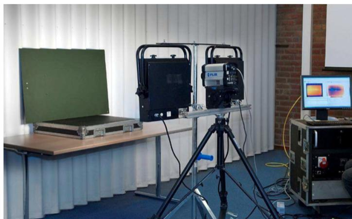
Figura 2.11 – Ensaio termográfico. (HEIDA; PLATENKAMP, 2011)
