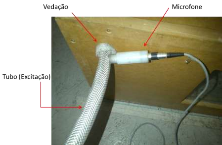
Figura 3. Figura esquemática do posicionamento do microfone para fonte calibrada
