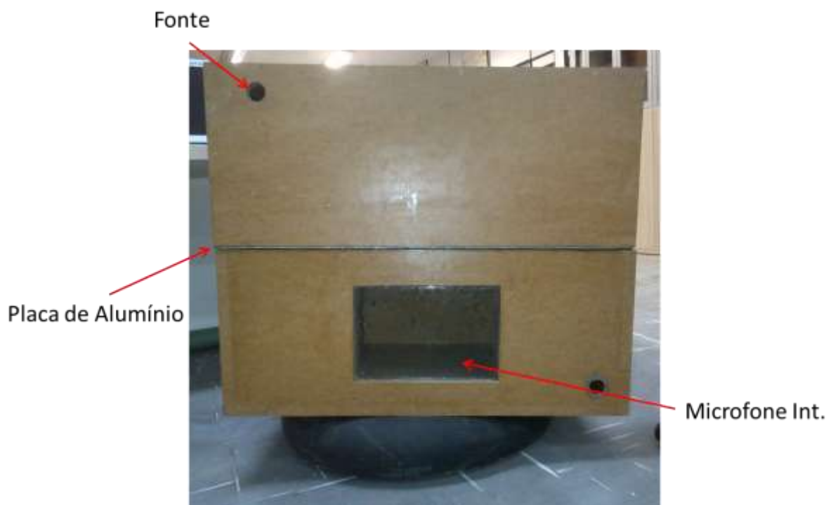
Figura 36. Foto do ensaio de duas cavidades acopladas por placa flexível
