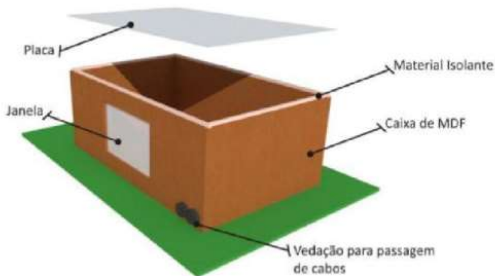
Figura 2. Caixa de auralização (FONSECA et al , 2010). (Modelo da cavidade experimental utilizada)
