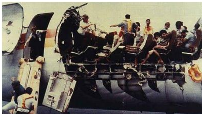
Figura 1.3 - Boeing 737 – que após alcançar a altitude de 7.000 metros parte do teto fratura. ( http://anengineersaspect.blogspot.com.br/2010/04/aloha-airlines-flight-243-fatigue.html )
