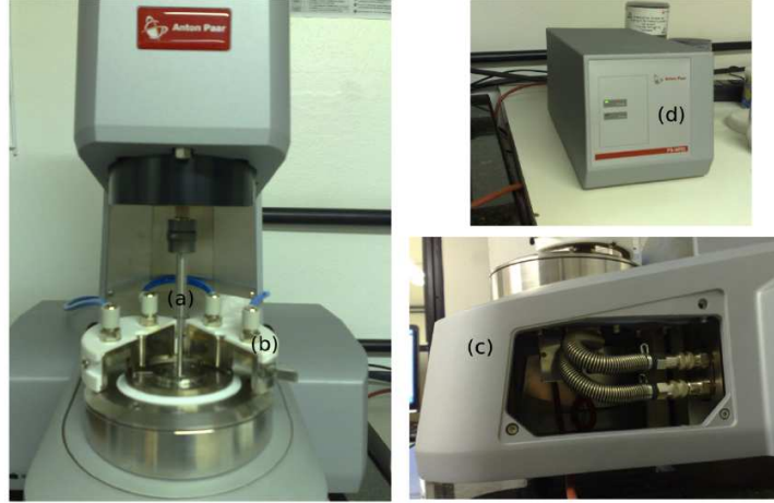
Figura 2.3: Reômetro com célula magnética utilizado na medição da viscosidade de um fluido magnético na presença de campo. (a) Disco rotativo, (b) cápsula de blindagem desmontada (c), detalhe do compartimento no qual é alojada a bobina do aparato magnetoreológico e (d) fonte de corrente elétrica utilizada para a geração de campo magnético controlável através de um eletroímã.
