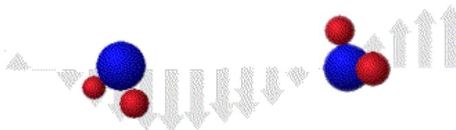
Figura 2: Esquema de moléculas de água se alinhando à onda eletromagnética.
