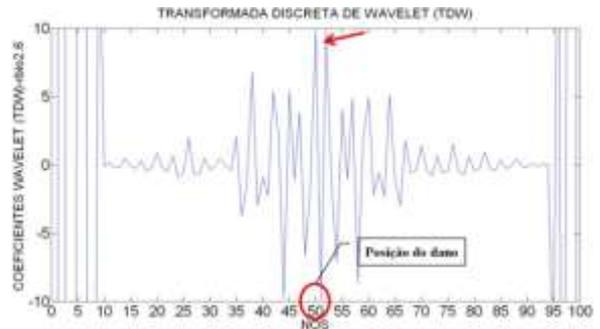
Figura 6.468- TDW-Modo1 para a viga V5D usando rbio2.6.
