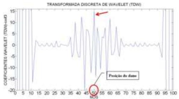
Figura 6.375- TDW-Modo1 para a viga V5D usando coif3.
