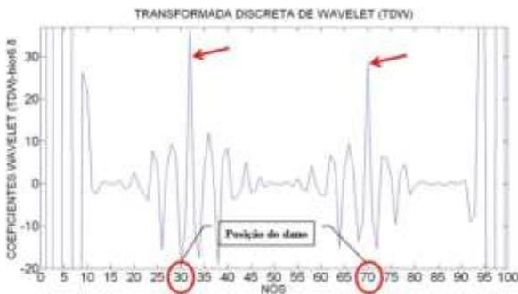
Figura 6.352- TDW-Modo1 para a viga V3D usando bior6.8.
