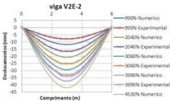
Figura 6.101- Comparação experimental - numérica viga V2E-2
