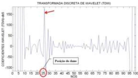
Figura 6.446- TDW-Modo2 para a viga V2D usando db5.
