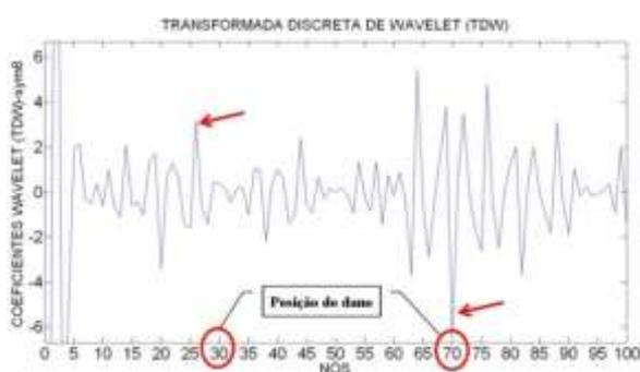
Figura 5.41- TDW viga V3E usando sym6.
