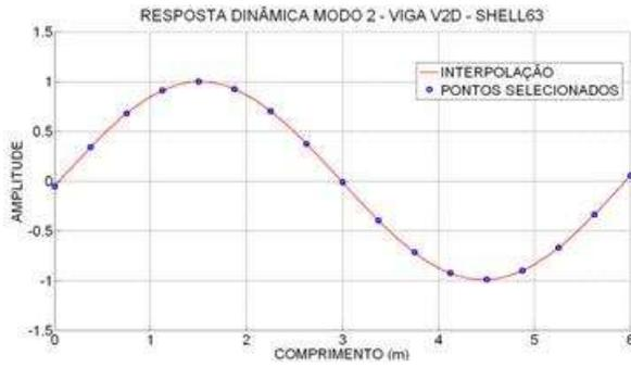
Figura 6.423- Interpolação Modo2 - viga V2D.
