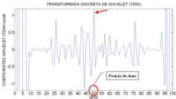
Figura 6.135- TDW viga V5E usando sym6.
