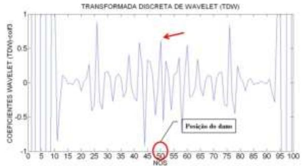
Figura 6.136- TDW viga V5E usando coif3.
