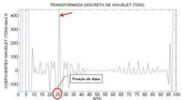
Figura 6.348- TDW-Modo2 para a viga V2D usando rbio2.6.
