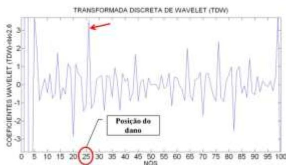
Figura 5.30-TDW viga V2E usando rbio2.6.
