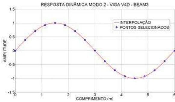
Figura 6.241- Interpolação Modo 2- viga V4D.
