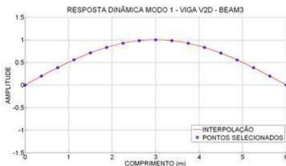
Figura 6.231- Interpolação Modo 1- viga V2D.
