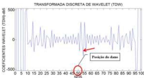
Figura 6.476- TDW-Modo3 para a viga V5D usando db5.
