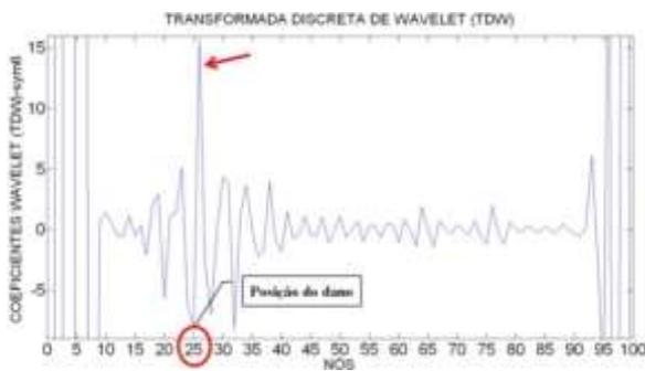
Figura 6.439- TDW-Modo1 para a viga V2D usando sym6.
