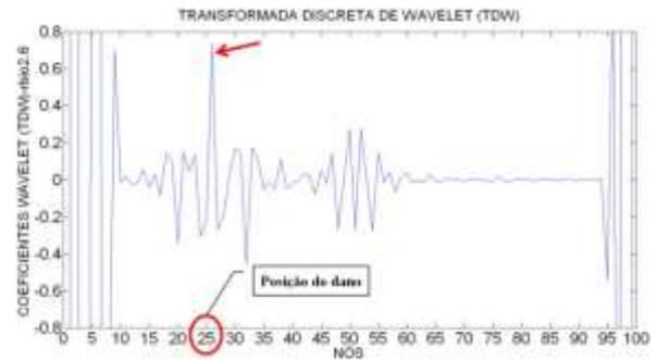
Figura 6.185- TDW viga V2E-2 usando rbio2.6.
