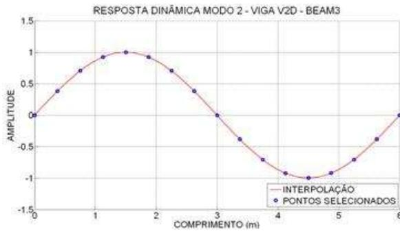
Figura 6.233- Interpolação Modo 2- viga V2D.
