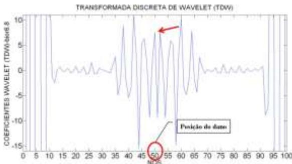
Figura 6.372- TDW-Modo1 para a viga V5D usando bior6.8.
