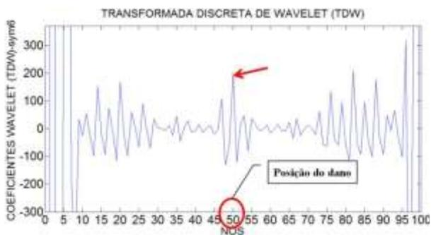
Figura 6.474- TDW-Modo3 para a viga V5D usando sym6.
