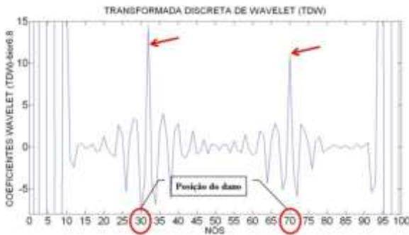
Figura 6.447- TDW-Modo1 para a viga V3D usando bior6.8.
