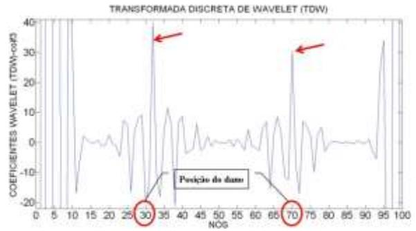
Figura 6.355- TDW-Modo1 para a viga V3D usando coif3.
