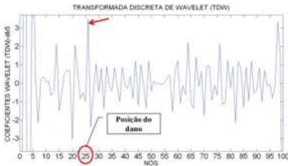
Figura 5.33- TDW viga V2E usando db5.
