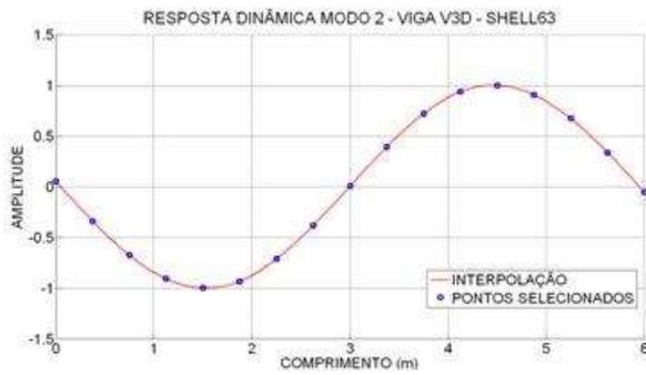
Figura 6.427- Interpolação Modo2 - viga V3D.
