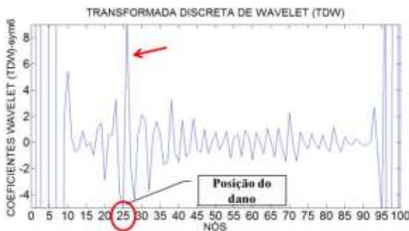
Figura 6.249- TDW- Modo 1 para a viga V2D usando sym6.
