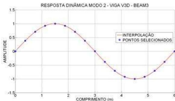
Figura 6.237- Interpolação Modo 2- viga V3D.
