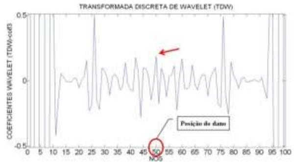
Figura 6.202- TDW viga V5E usando coif3.
