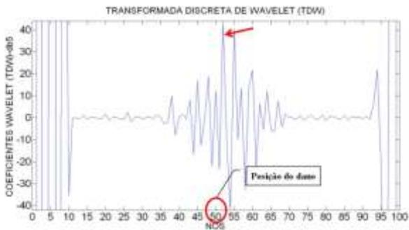
Figura 6.376- TDW-Modo1 para a viga V5D usando db5.
