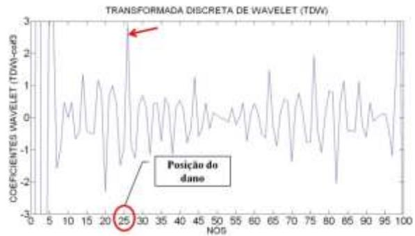
Figura 5.32-TDW viga V2E usando coif3.
