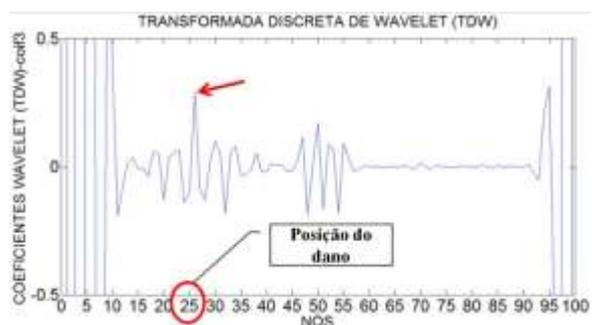
Figura 6.50- TDW viga V2E usando coif3.
