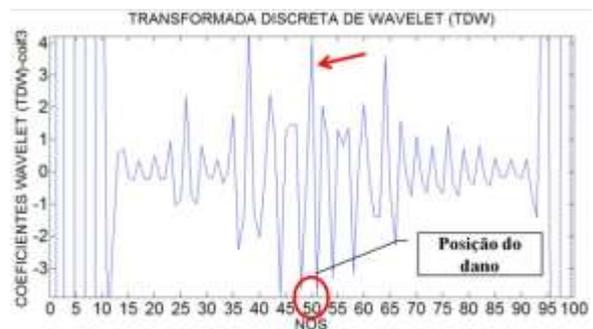
Figura 6.280- TDW- Modo 1 para a viga V5D usando coif3.
