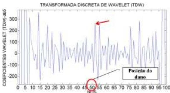
Figura 6.286- TDW- Modo 3 para a viga V5D usando db5.
