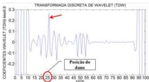
Figura 6.48- TDW viga V2E usando bior6.8.
