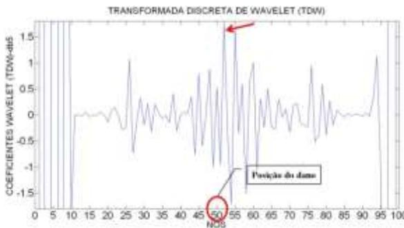
Figura 6.137- TDW viga V5E usando db5.
