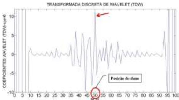
Figura 6.469- TDW-Modo1 para a viga V5D usando sym6.
