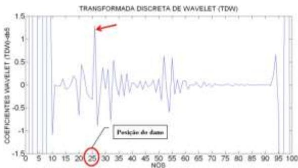
Figura 6.117- TDW viga V2E usando db5.
