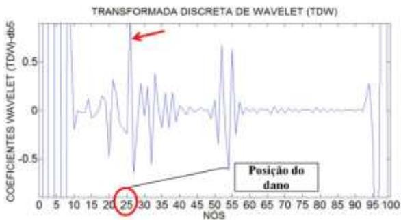
Figura 6.56- TDW viga V2E-2 usando db5.
