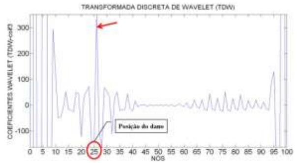
Figura 6.350- TDW-Modo2 para a viga V2D usando coif3.
