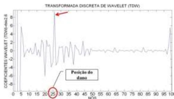
Figura 5.35-TDW viga V2E-2 usando rbio2.6.
