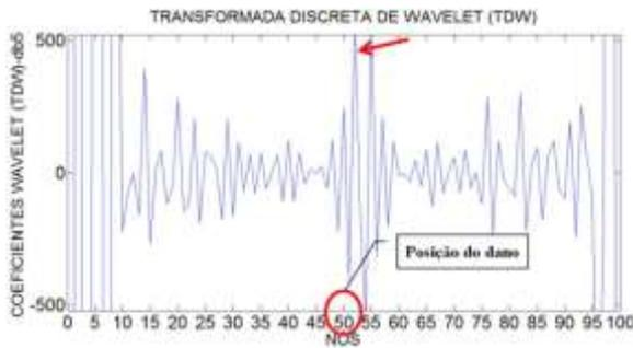
Figura 6.381- TDW-Modo3 para a viga V5D usando db5.
