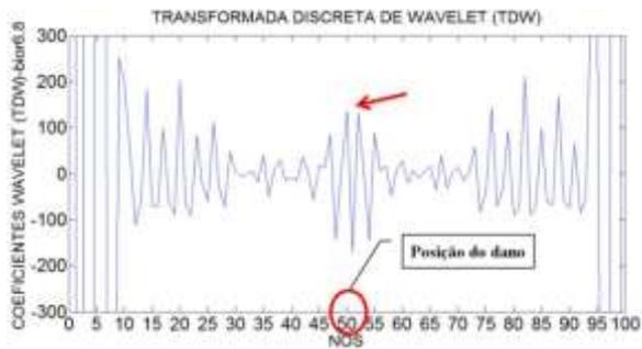
Figura 6.377- TDW-Modo3 para a viga V5D usando bior6.8.
