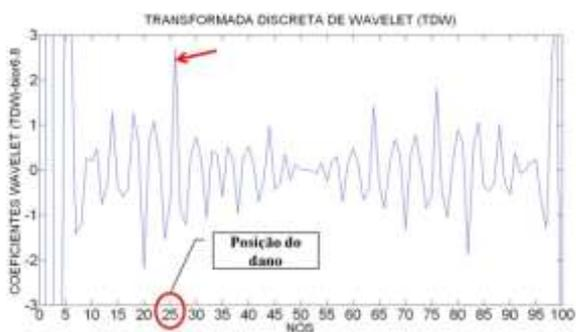
Figura 5.29-TDW viga V2E usando rbio2.6.
