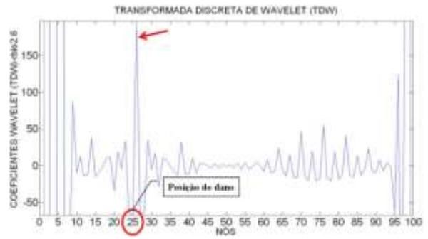
Figura 6.443- TDW-Modo2 para a viga V2D usando rbio2.6.
