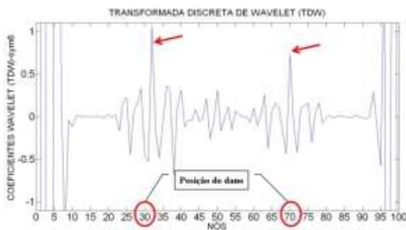
Figura 6.125- TDW viga V3E usando sym6.
