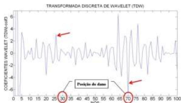
Figura 5.42- TDW viga V3E usando coif3.
