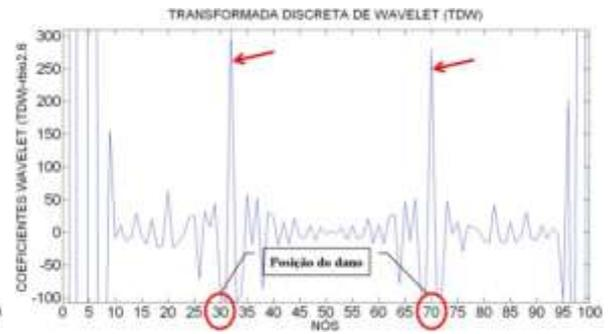
Figura 6.358- TDW-Modo2 para a viga V3D usando rbio2.6.
