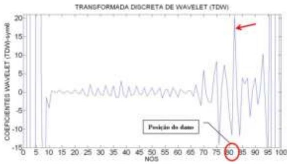
Figura 6.364- TDW-Modo1 para a viga V4D usando sym6.
