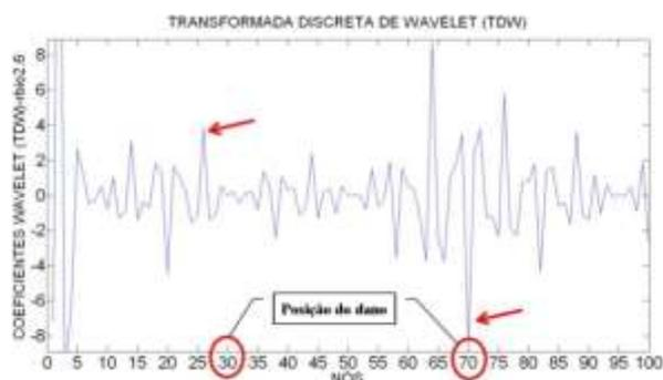
Figura 5.40- TDW viga V3E usando rbo2.6.
