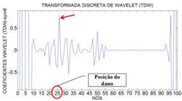
Figura 6.54- TDW viga V2E-2 usando sym6.
