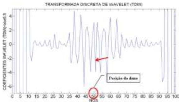
Figura 6.467- TDW-Modo1 para a viga V5D usando bior6.8.
