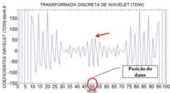
Figura 6.282- TDW- Modo 2 para a viga V5D usando bior6.8.
