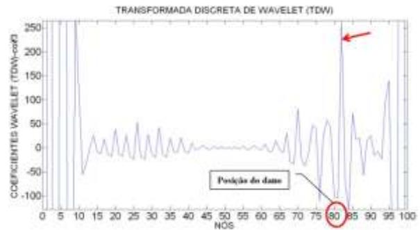
Figura 6.370- TDW-Modo2 para a viga V4D usando coif3.
