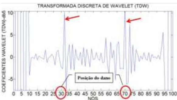
Figura 6.261- TDW- Modo 1 para a viga V3D usando db5.
