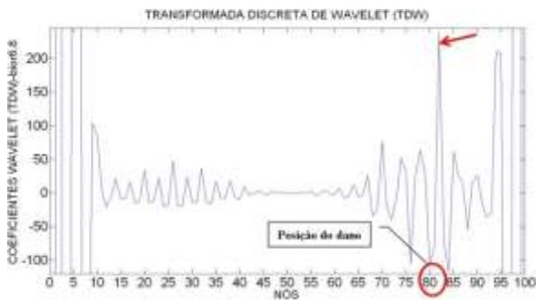
Figura 6.367- TDW-Modo2 para a viga V4D usando bior6.8.
