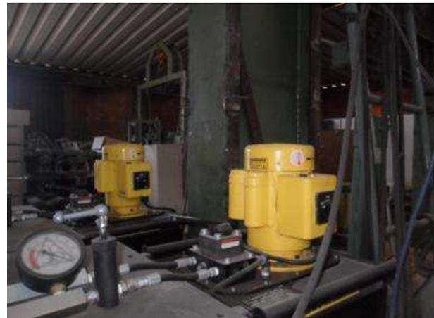
Figura 5.15- Bombas Hidráulicas
