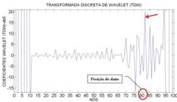
Figura 6.366- TDW-Modo1 para a viga V4D usando db5.
