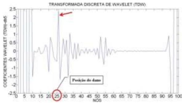
Figura 6.122- TDW viga V2E-2 usando db5.
