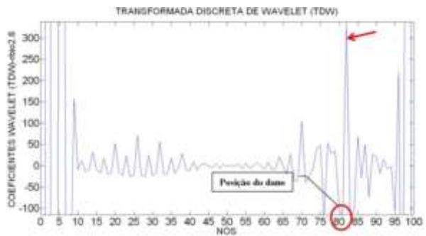
Figura 6.368- TDW-Modo2 para a viga V4D usando rbio2.6.
