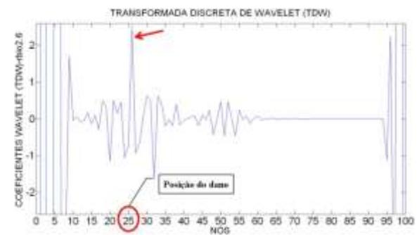
Figura 6.119- TDW viga V2E-2 usando rbio2.6.
