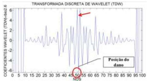
Figura 6.278- TDW- Modo 1 para a viga V5D usando rbio2.6.
