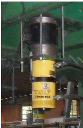
Figura 5.14- Atuador Hidráulico
