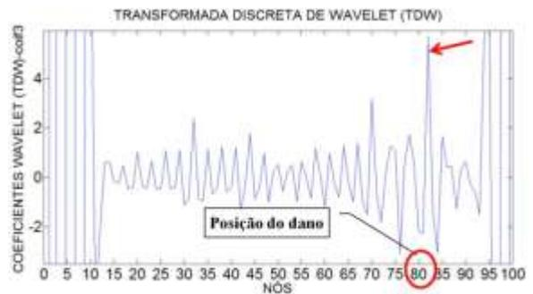
Figura 6.270- TDW- Modo 1 para a viga V4D usando coif3.
