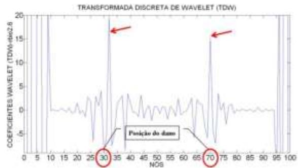
Figura 6.448- TDW-Modo1 para a viga V3D usando rbio2.6.
