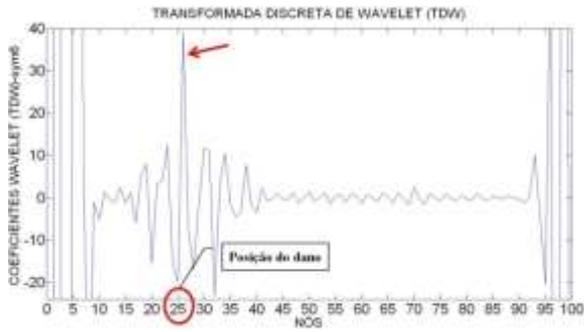
Figura 6.344- TDW-Modo1 para a viga V2D usando sym6.
