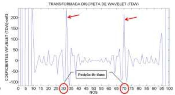
Figura 6.360- TDW-Modo2 para a viga V3D usando coif3.
