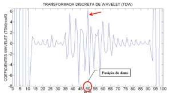
Figura 6.470- TDW-Modo1 para a viga V5D usando coif3.
