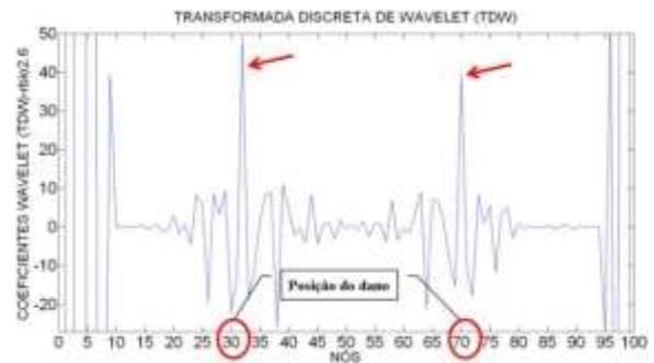
Figura 6.353- TDW-Modo1 para a viga V3D usando rbio2.6.
