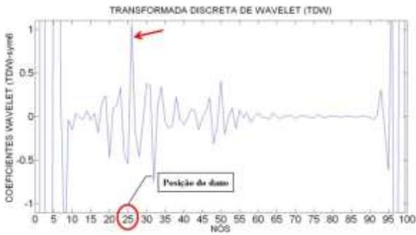
Figura 6.115- TDW viga V2E usando sym6.
