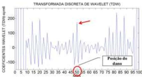
Figura 6.284- TDW- Modo 2 para a viga V5D usando sym6.
