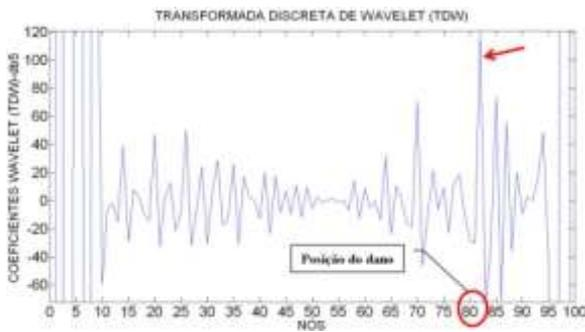
Figura 6.466- TDW-Modo2 para a viga V4D usando db5.
