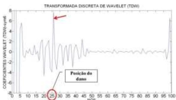
Figura 5.36- TDW viga V2E-2 usando sym6.
