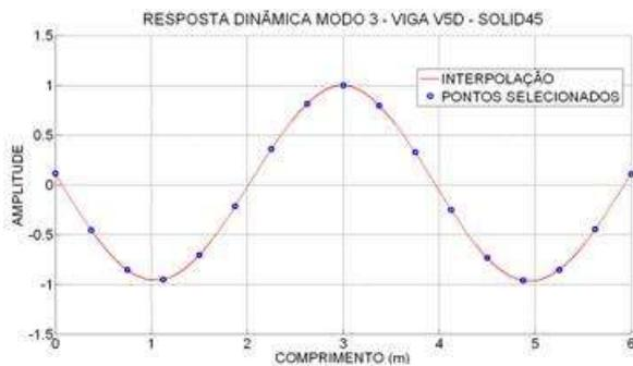
Figura 6.340 - Interpolação Modo 3- viga V5D.
