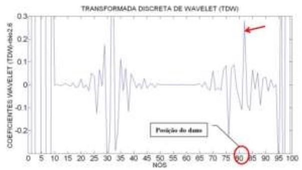
Figura 6.129- TDW viga V4E usando rbio2.6.
