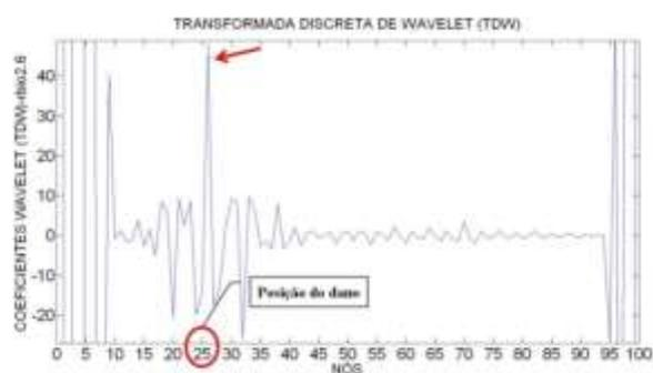
Figura 6.343- TDW-Modo1 para a viga V2D usando rbio2.6.
