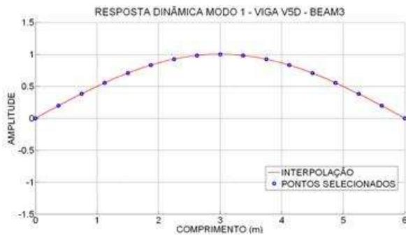
Figura 6.243- Interpolação Modo 1- viga V5D.
