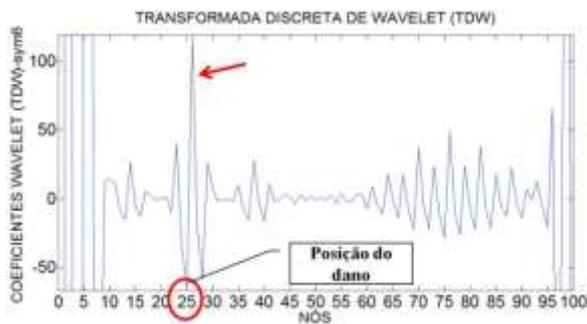
Figura 6.254- TDW- Modo 2 para a viga V2D usando sym6.
