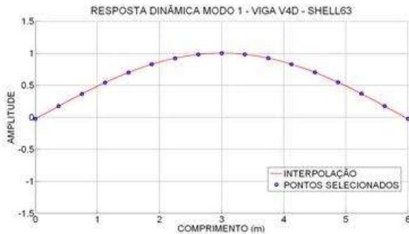
Figura 6.429- Interpolação Modo1 - viga V4D.
