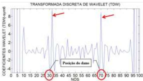
Figura 6.259- TDW- Modo 1 para a viga V3D usando sym6.
