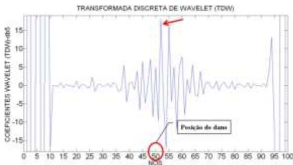
Figura 6.471- TDW-Modo1 para a viga V5D usando db5.
