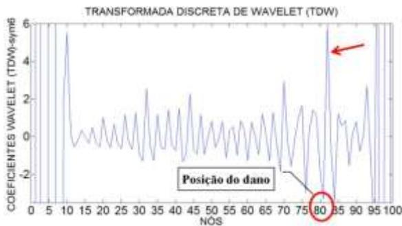
Figura 6.269- TDW- Modo 1 para a viga V4D usando sym6.
