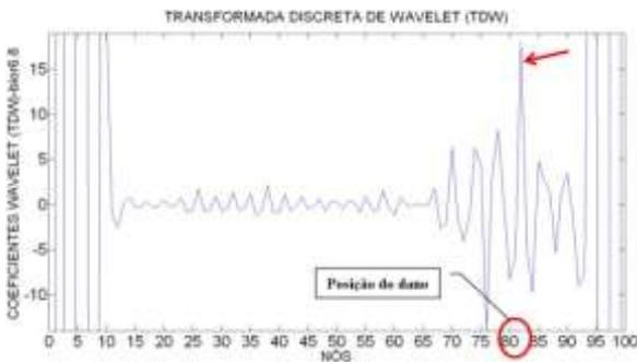
Figura 6.362- TDW-Modo1 para a viga V4D usando bior6.8.
