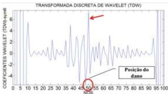
Figura 6.279- TDW- Modo 1 para a viga V5D usando sym6.
