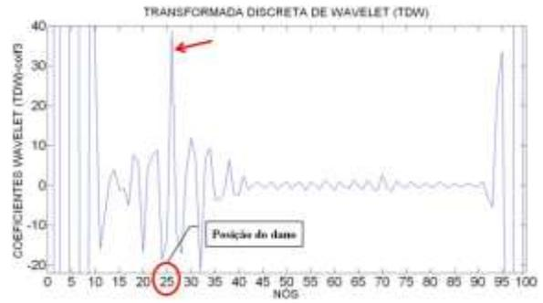
Figura 6.345- TDW-Modo1 para a viga V2D usando coif3.
