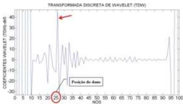
Figura 6.346- TDW-Modo1 para a viga V2D usando db5.
