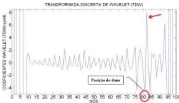
Figura 6.459- TDW-Modo1 para a viga V4D usando sym6.
