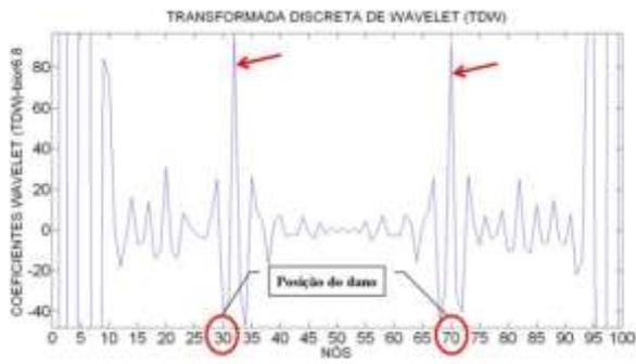
Figura 6.452- TDW-Modo2 para a viga V3D usando bior6.8.
