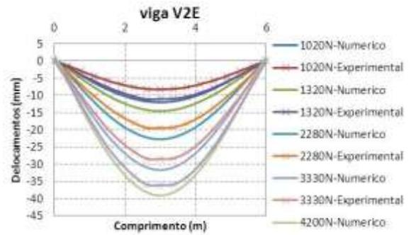
Figura 6.100- Comparação experimental - numérica viga V2E
