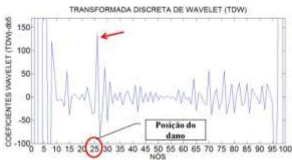
Figura 6.256- TDW- Modo 2 para a viga V2D usando db5.
