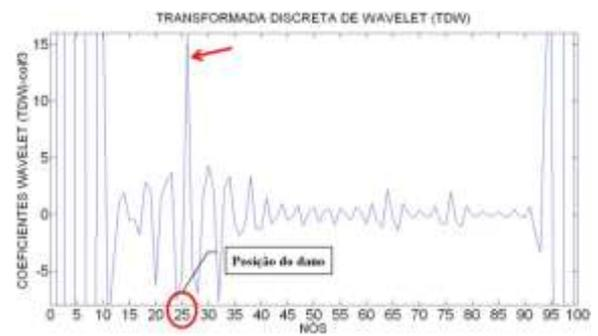
Figura 6.440- TDW-Modo1 para a viga V2D usando coif3.
