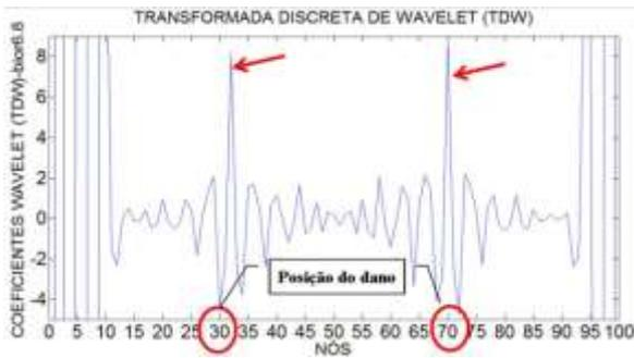
Figura 6.257- TDW- Modo 1 para a viga V3D usando bior6.8.
