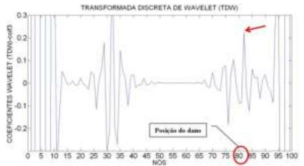
Figura 6.131- TDW viga V4E usando coif3.
