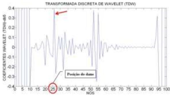
Figura 6.183- TDW viga V2E usando db5.
