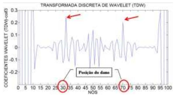
Figura 6.60- TDW viga V3E usando coif3.
