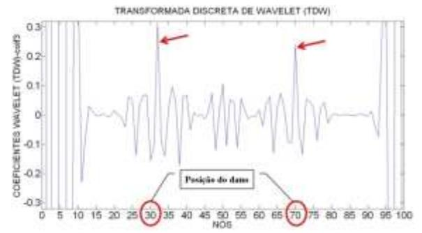
Figura 6.192- TDW viga V3E usando coif3.
