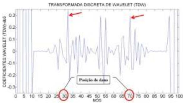
Figura 6.193- TDW viga V3E usando db5.
