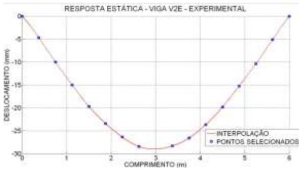
Figura 5.23- Interpolação viga V2E.
