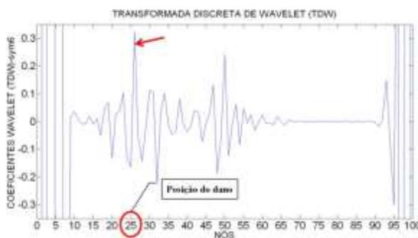
Figura 6.181- TDW viga V2E usando sym6.
