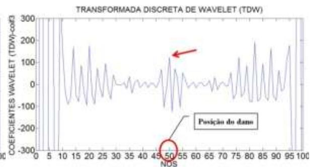
Figura 6.475- TDW-Modo3 para a viga V5D usando coif3.
