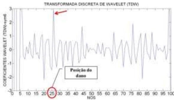
Figura 5.31-TDW viga V2E usando sym6.
