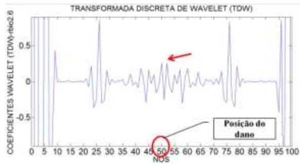
Figura 6.68- TDW viga V5E usando rbio2.6.
