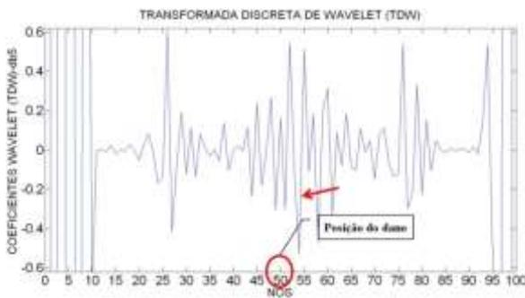
Figura 6.203- TDW viga V5E usando db5.
