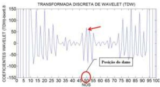
Figura 6.472- TDW-Modo3 para a viga V5D usando bior6.8.
