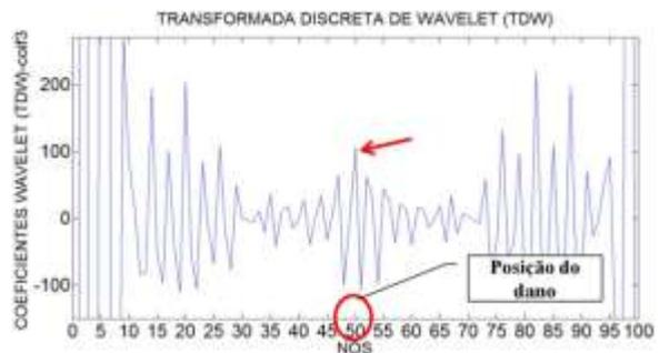
Figura 6.285- TDW- Modo 2 para a viga V5D usando coif3.
