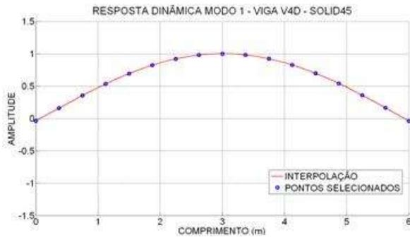
Figura 6.334 - Interpolação Modo 1- viga V4D.
