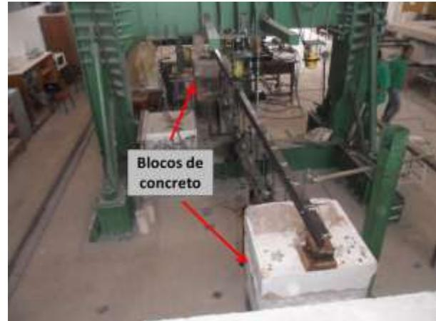
Figura 5.13- Blocos de concreto para apoiar a viga.
