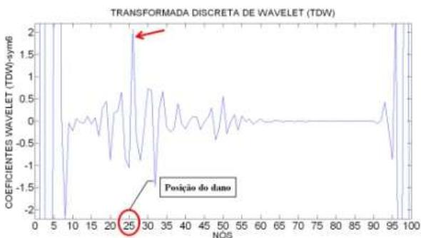
Figura 6.120- TDW viga V2E-2 usando sym6.
