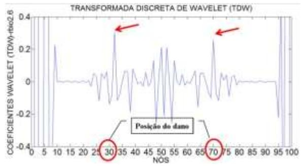
Figura 6.58- TDW viga V3E usando rbio2.6.
