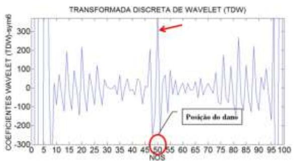
Figura 6.379- TDW-Modo3 para a viga V5D usando sym6.
