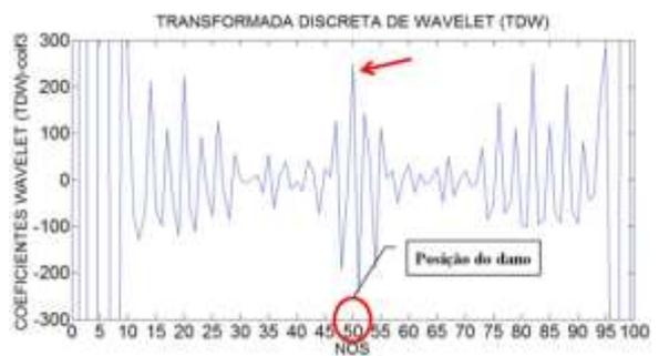
Figura 6.380- TDW-Modo3 para a viga V5D usando coif3.
