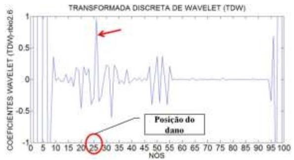
Figura 6.53- TDW viga V2E-2 usando rbio2.6.
