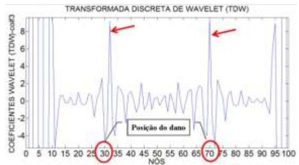
Figura 6.260- TDW- Modo 1 para a viga V3D usando coif3.
