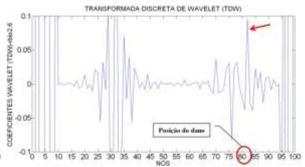
Figura 6.195- TDW viga V4E usando rbio2.6.
