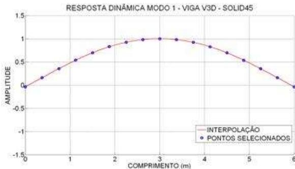
Figura 6.330 - Interpolação Modo 1- viga V3D.
