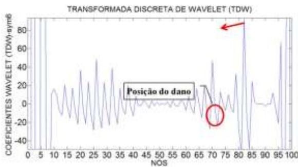
Figura 6.274- TDW- Modo 2 para a viga V4D usando sym6.
