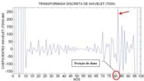
Figura 6.371- TDW-Modo2 para a viga V4D usando db5.
