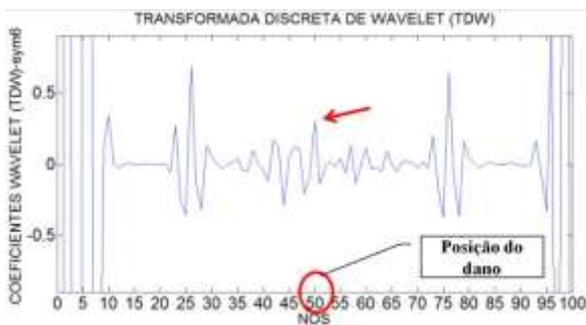
Figura 6.69- TDW viga V5E usando sym6.
