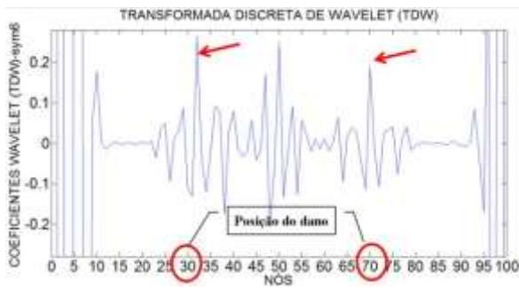
Figura 6.59- TDW viga V3E usando sym6.
