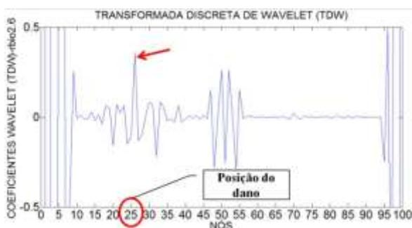
Figura 6.47-TDW viga V2E usando rbio2.6.
