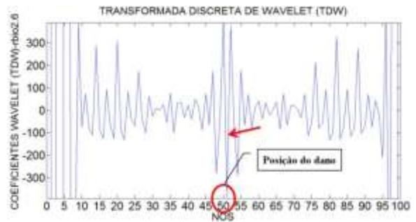
Figura 6.378- TDW-Modo3 para a viga V5D usando rbio2.6.
