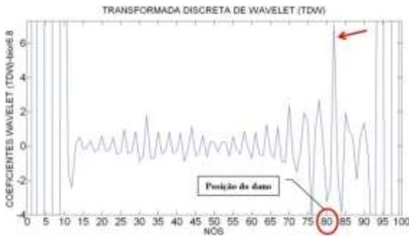
Figura 6.457- TDW-Modo1 para a viga V4D usando bior6.8.
