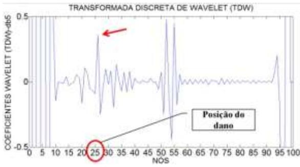
Figura 6.51- TDW viga V2E usando db5.
