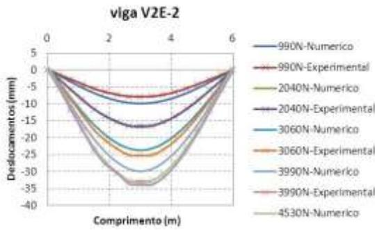
Figura 6.167- Comparação experimental - numérica viga V2E-2.
