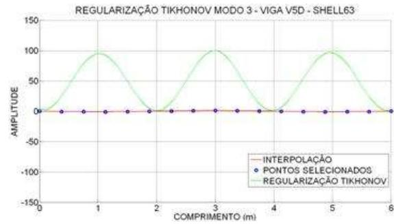
Figura 6.435- Interpolação Modo3 - viga V5D. Figura 6.436- Regularização Modo 3-viga V5D.
