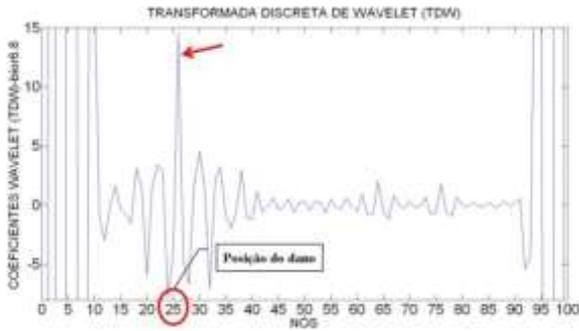
Figura 6.437- TDW-Modo1 para a viga V2D usando bior6.8.
