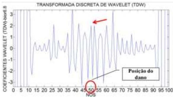
Figura 6.277- TDW- Modo 1 para a viga V5D usando bior6.8.
