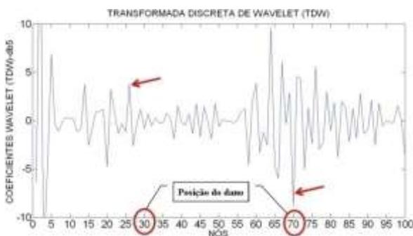
Figura 5.43- TDW viga V3E usando db5.
