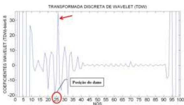
Figura 6.342- TDW-Modo1 para a viga V2D usando bior6.8.
