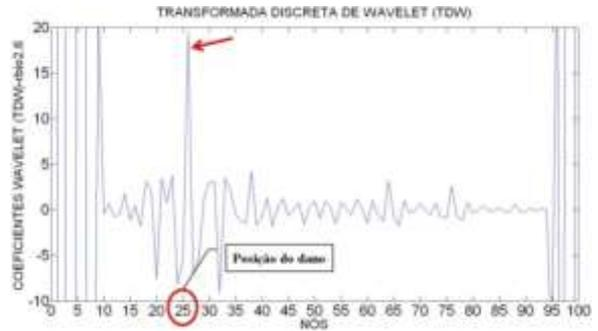
Figura 6.438- TDW-Modo1 para a viga V2D usando rbio2.6.
