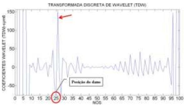
Figura 6.444- TDW-Modo2 para a viga V2D usando sym6.
