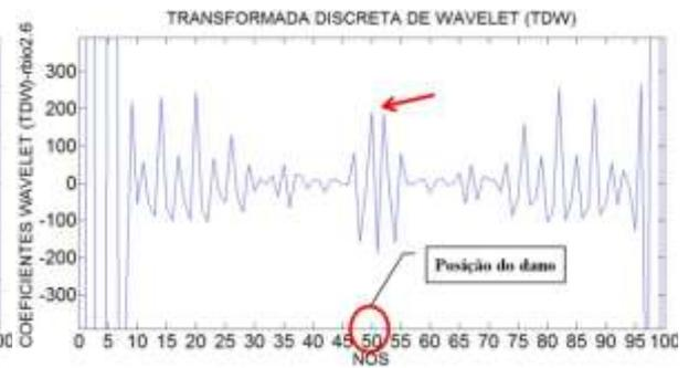
Figura 6.473- TDW-Modo3 para a viga V5D usando rbio2.6.
