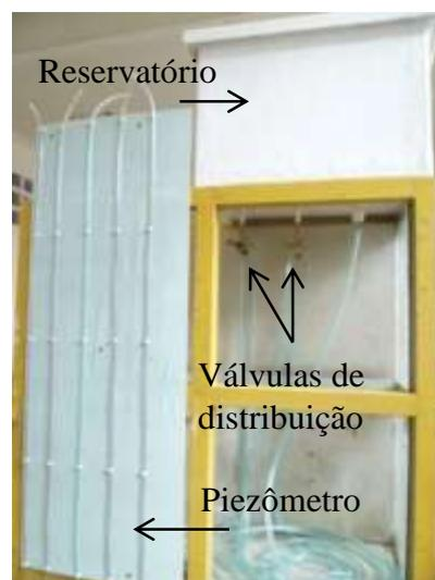
Figura 3.6 – Detalhe do reservatório e o piezômetro.
