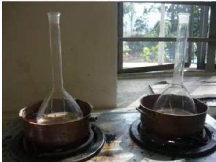
Figura 3.4 – Ensaio massa específica dos grãos.
