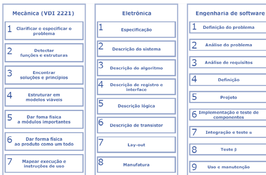
FIGURA 5.8: Exemplo das atividades principais do projeto mecânico, eletrônico e de software . Fonte: Bernardi et al. (2004).
