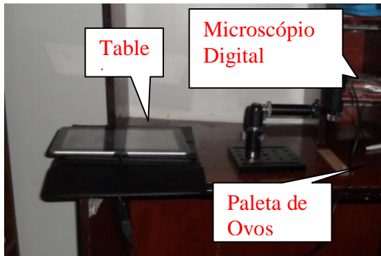
Fig. 8. Montagem do sistema de digitalização de imagens hardware + software.
