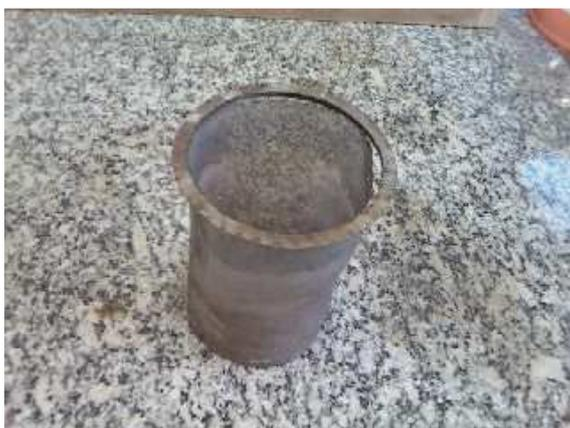
**Figura 3.2-** Cestos utilizados para manter o contato da semente com o solvente.
