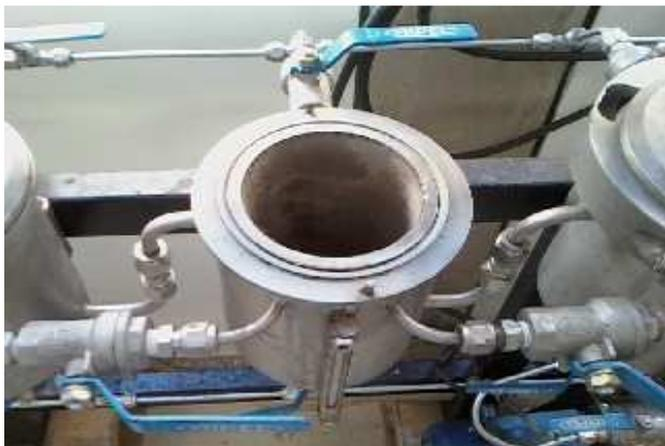
**Figura 3.3-** Autoclaves com os cestos utilizados para a extração.
