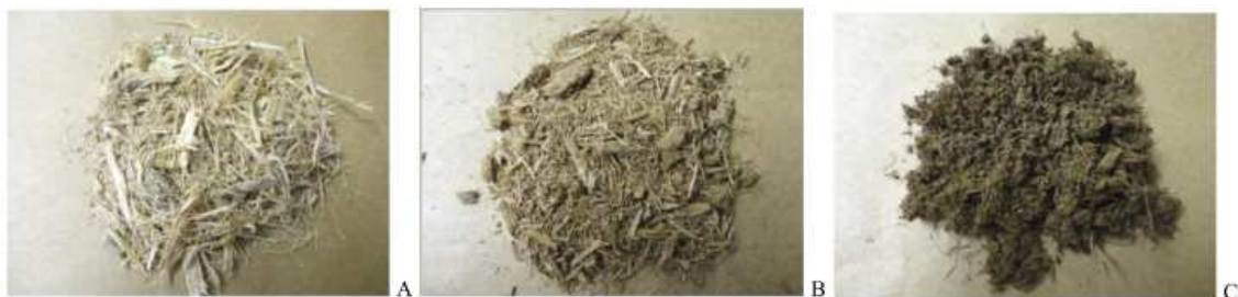
Figura 6.1. Amostras de bagaço de cana de açúcar. Bagaço de cana não tratado (A), bagaço de cana hidrolisado por ácido sulfúrico (B), bagaço de cana explodido a vapor (C).
