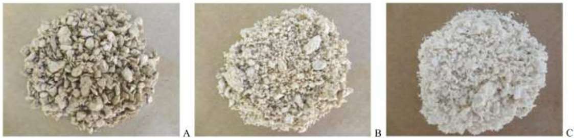
Figura 5.2. Amostras de polpas de celulose. Polpa de celulose escura (A), polpa de celulose pré-branqueada com O 2 (B) e polpa de celulose clara (C).
