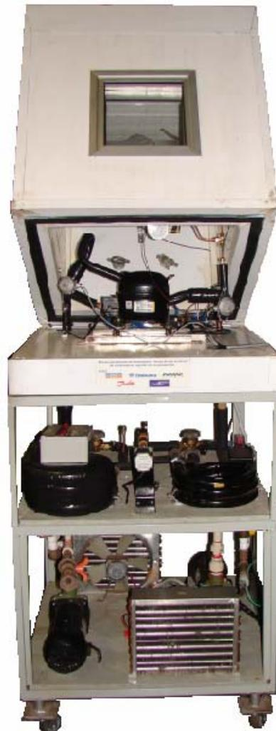
Figura 4.1 – Bancada construída e utilizada para os ensaios experimentais.
