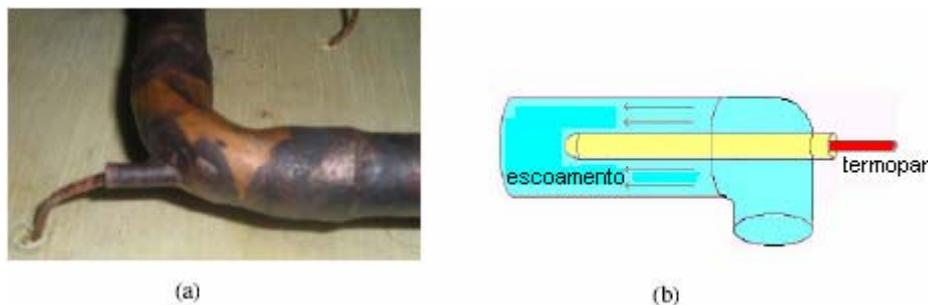
Figura 4.17 – (a) foto do poço termométrico, (b) figura esquemática do poço termométrico.
