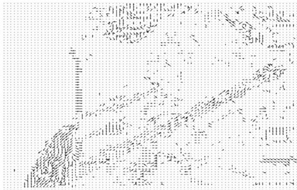
Figura 5.7: Fluxo Óptico obtido com base na diferença dos quadros 1 e 2 [6].
