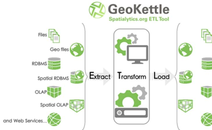
Figura 3.3: Ferramenta de extração, carregamento e transformação de dados Geokettle [25].
