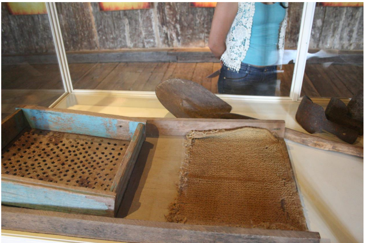
Figura 23 – Instrumento utilizado para lavar e reter o ouro nos garimpos de Goiás. Foto do autor, Museu das Bandeiras – cidade de Goiás, 2012.
