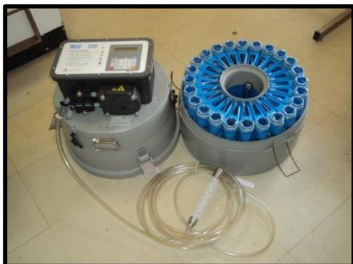
Figura 4-104. Amostrador automático por dentro: com o computador para processamento e com os locais de armazenamento das amostras.
