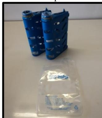
Figura 4-105. Embalagem plástica de 1L para acondicionar as amostras junto com os encaixes azuis padrão para o amostrador.
