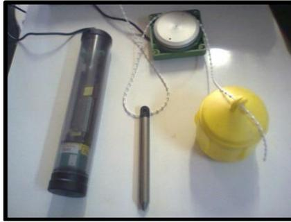
Figura 4-92. Linígrafo de bóia utilizado para os dois pontos de lançamento.
