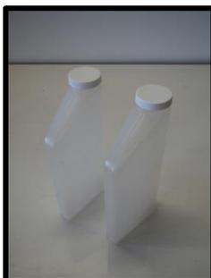
Figura 4-106. Garrafas plásticas de 1L utilizadas dentro dos amostradores automáticos (2º tipo).
