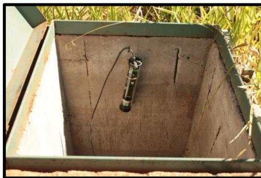
Figura 4-99. Caixa de concreto aberta com o linígrafo.
