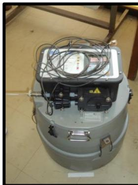
Figura 4-103. Amostrador automático sem a tampa.
