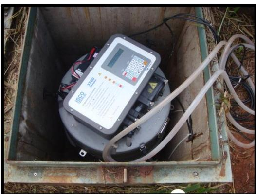
Figura 4-107. Amostrador Automático instalado na Bacia do C.O.
