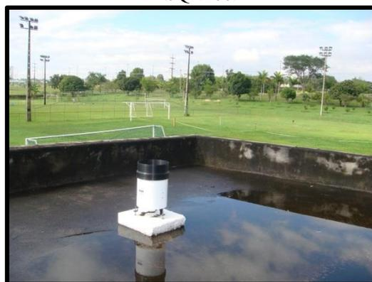
Figura 4-87. Pluviógrafos no telhado do Iate Clube Brasília.
