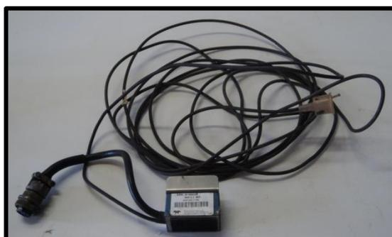
Figura 4-109. Sensor de nível padrão da Isco.
