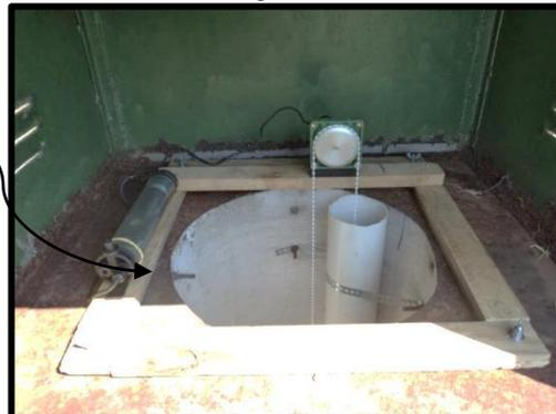
Figura 4-96. O local onde o linígrafo foi afixado para armazenamento dos dados.
