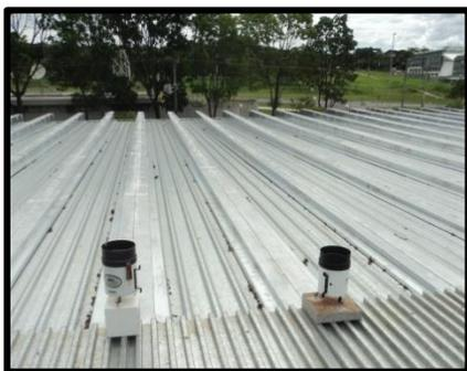
Figura 4-84. Pluviógrafos no telhado do prédio SG-12 da UnB.
