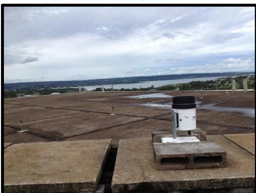
Figura 4-86. Pluviógrafo no telhado do DNIT.
