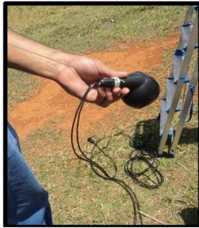
Figura 4-110. Sensor de nível composto pela bóia de mercúrio.
