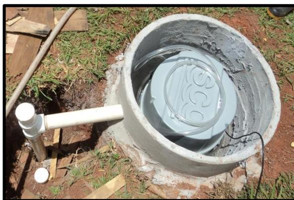
Figura 4-108. Amostrador Automático instalado na Bacia do Iate.
