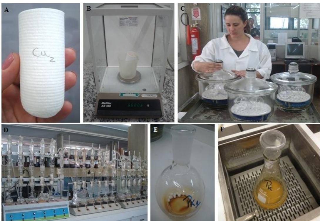
Figura 13. Andamento das Análises Químicas. A) tubo de celulose identificado; B) pesagem do material moído; C) processo de esterilização dos balões; D) extrator Soxhlet; E) balão com amostra seca; F) amostras em banho-maria – ensaio de lignina insolúvel.
