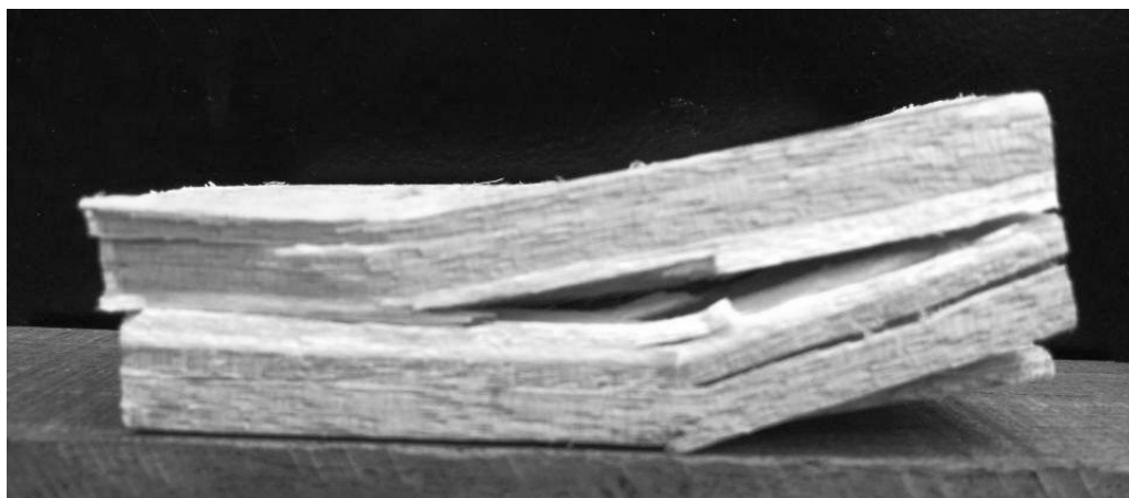
Figura 35. Delaminação em corpo-de-prova do tratamento 1 (painéis LVL produzidos com lâminas de amescla e paricá).
