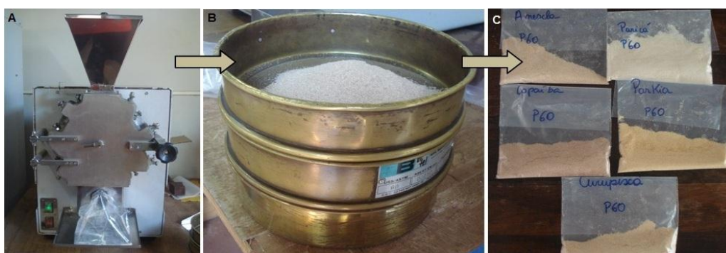
Figura 12. A) moinho de facas; B) sistema de peneiras vibratórias; C) fração retida entre as peneiras de 60 e 40 mesh , separadas e identificadas.
