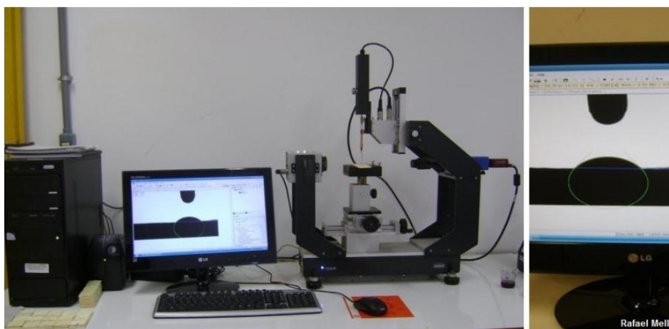
Figura 10. Goniômetro utilizado para realização dos ensaios de molhabilidade.
