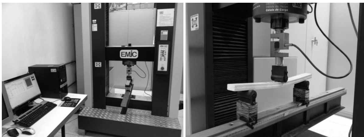
Figura 24. Realização do ensaio de resistência à flexão estática com aplicação da carga centralizada sobre dois apoios.
