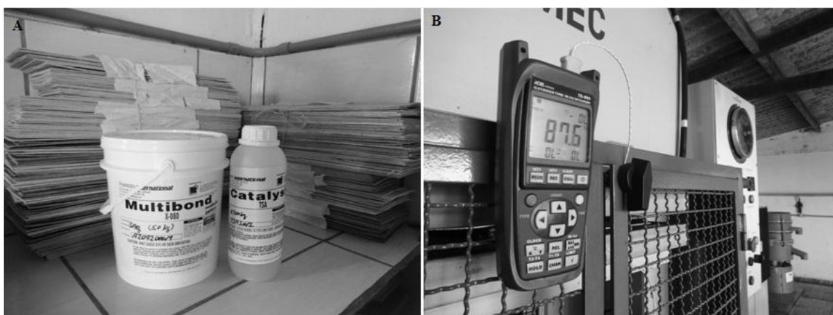
Figura 22. Confeccção dos painéis. A) Lâminas e adesivo utilizados; B) Acompanhamento da temperatura durante a prensagem dos painéis.
