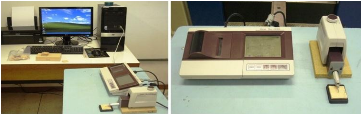
Figura 8. Rugosímetro utilizado para caracterizar a superfície das lâminas.
