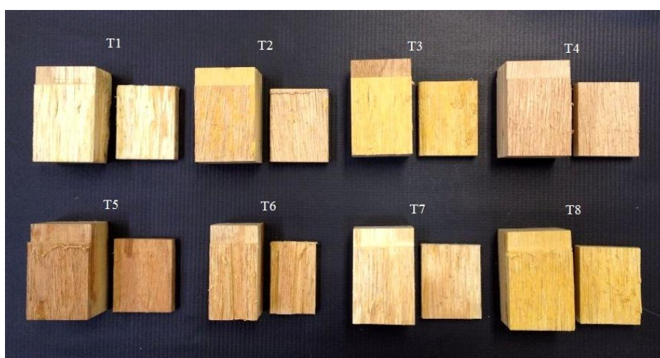
Figura 37. Ruptura em cisalhamento paralelo à linha de cola para os painéis confeccionados por tratamento. T1 – 3A/3Pa/3A; T2 – 3Pk/3A/3Pk; T3 – 3Co/3Pk/3Co; T4 – 9A; T5 – 9Co; T6 – 9Cu; T7 – 9Pa; T8 – 9Pk.
