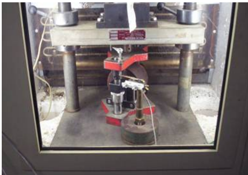
Figura 3.29 - Detalhe do dispositivo que controla a deformação limite do corpo-de-prova estabelecida para o ensaio de fadiga.
