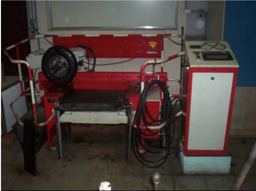
Figura 3.31 - Mesa compactadora das placas das misturas asfálticas.
