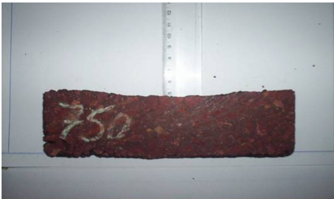
Figura 5.36 - Corte transversal da placa asfáltica após ensaio da mistura J406/filer laterítico
