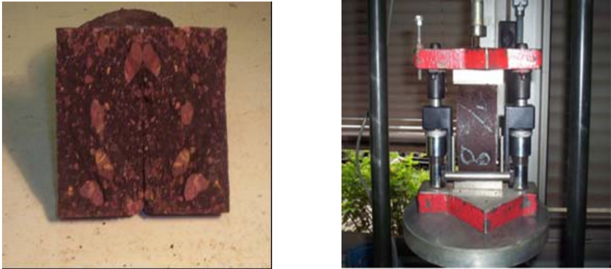
Figura 3.26 - Corpo-de-prova após ensaio de resistência à tração
