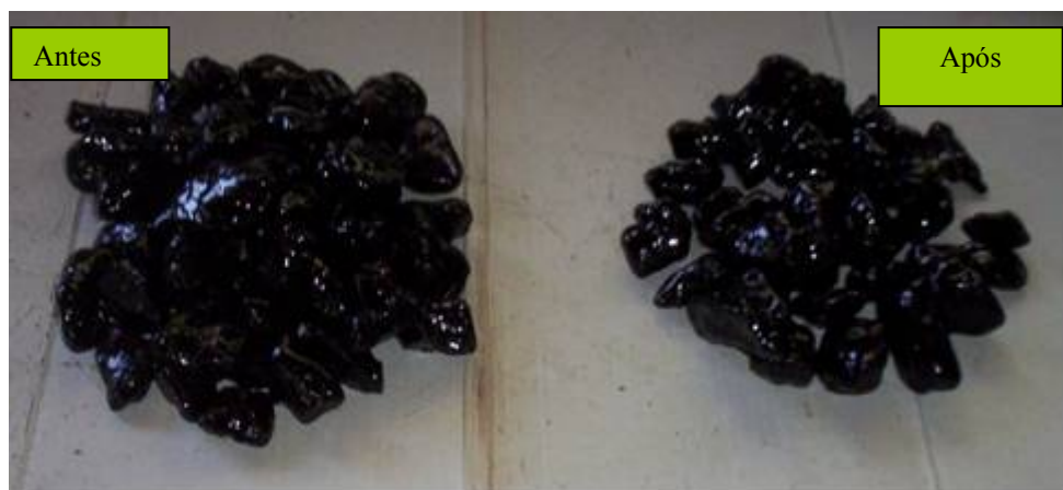
Figura 4.2 - Ensaio de adesividade do agregado J406 com lavagem
