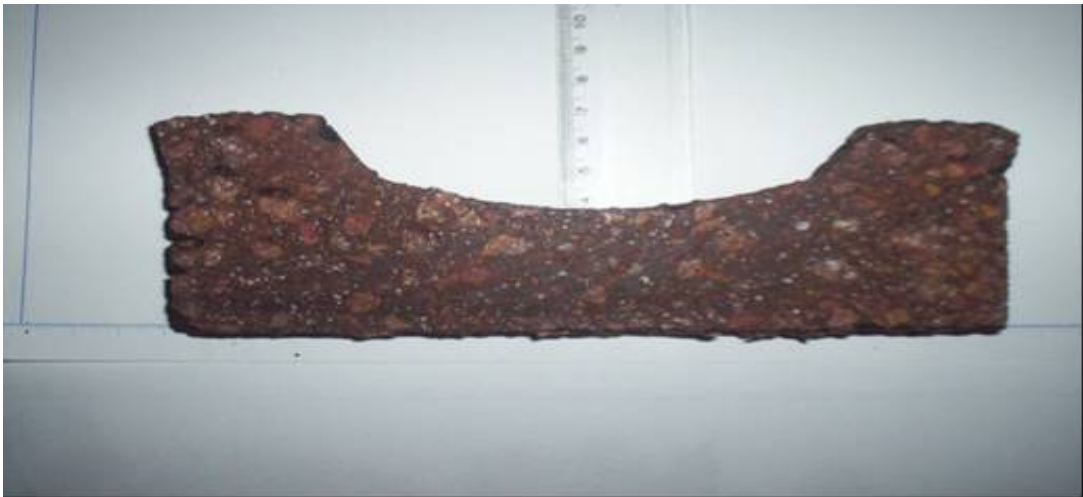
Figura 5.38 - Corte transversal da placa asfáltica após ensaio da mistura BVRR/filer laterítico
