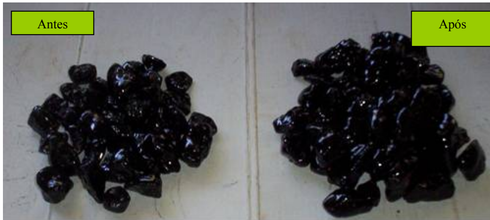
Figura 4.1 - Ensaio de adesividade do agregado J406 sem lavagem
