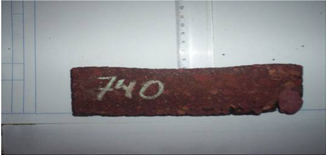
Figura 5.37 - Corte transversal da placa asfáltica após ensaio da mistura J406/filer cal
