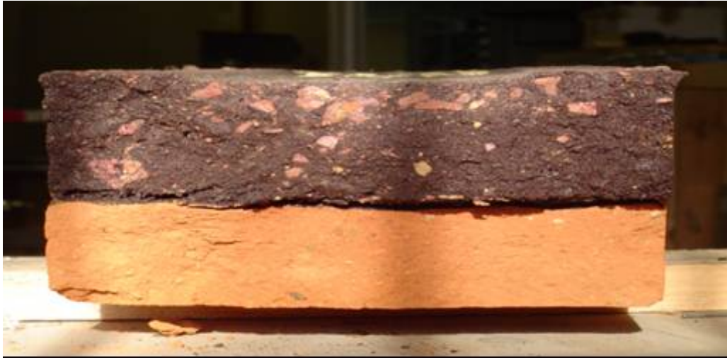
Figura 5.40 - Corte transversal da placa mista após ensaio - solo/mistura J406/filer laterítico.
