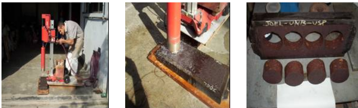
Figura 3.34 - Detalhe do equipamento e da extração de corpos-de-prova de concreto betuminoso.
