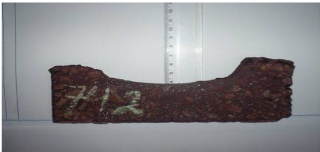
Figura 5.39 - Corte transversal da placa asfáltica após ensaio da mistura BVRR/filer cal
