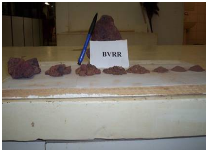
Figura 3.7 - Aspecto do agregado “ in natura ” e após britagem e peneiramento
