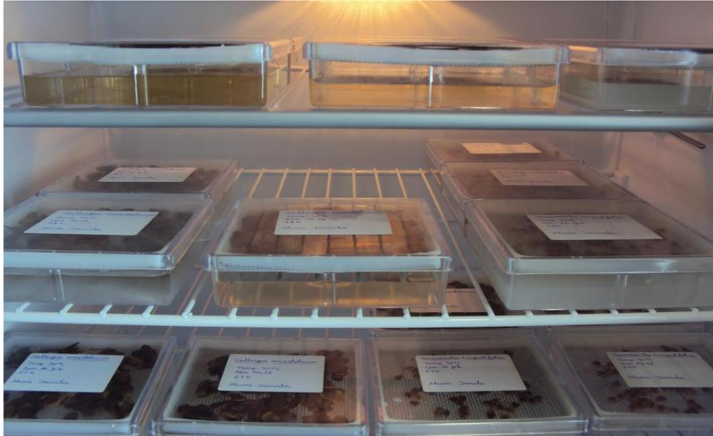
Figura 5.2: Teste de Envelhecimento acelerado pelo método gerbox. Foto: D.V.O. 2012.
