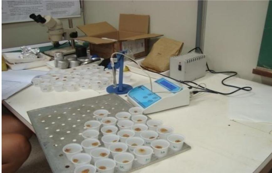
Figura 5.3 – Condutivímetro de bancada modelos Q405M. Foto: K.M.O.R. 2011.
