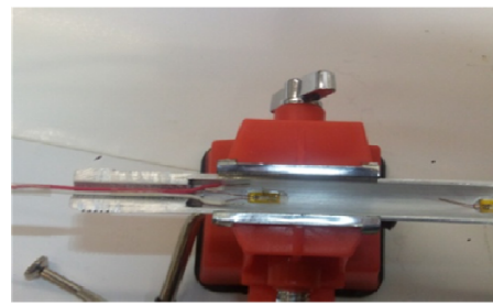
(b) Extensômetros colados no topo e no meio da estaca
