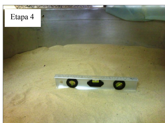
(d) Nivelamento do material lançado
