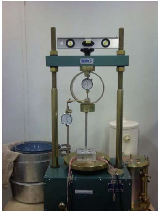
Figura 3.17. Ensaio de aferição das estacas utilizadas nos ensaios.
