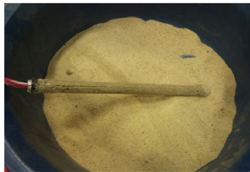
(b) Estaca com revestimento finalizado e pronta para ensaio
