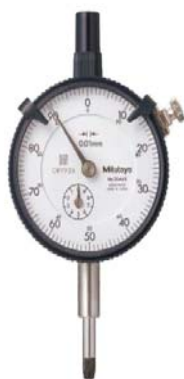
Figura 3.3. Relógio comparador utilizado para aferição de deslocamentos verticais.
