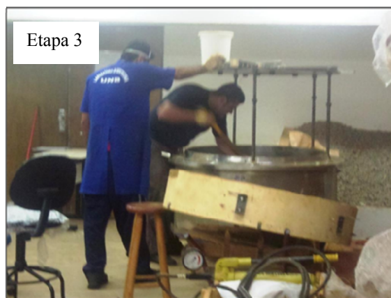
(c) Lançamento do material na camada
