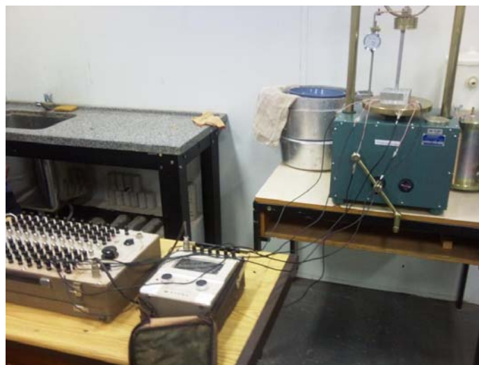
Figura 3.18. Utilização de um bloco de alumínio para aferição das estacas.
