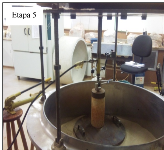
Figura 3.21. Compactação da primeira das camadas de areia.
