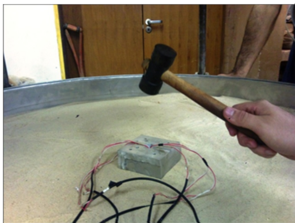
(a) Instalação da estaca através de cravação
