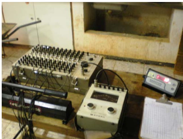
Figura 3.2. Sistema de aquisição de dados: no canto superior esquerdo da mesa encontra-se a mesa leitora (SM-60D), ao centro na parte inferior o Strain Meter e no canto superior direito o relógio de carga.
