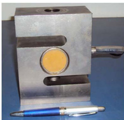
Figura 3.4. Célula de carga empregada nos ensaios.
