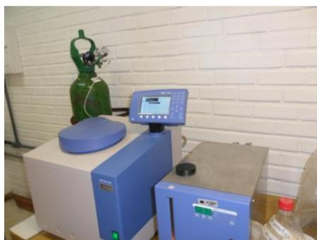
Figura 4 – Calorímetro para determinação do poder calorífico superior.
