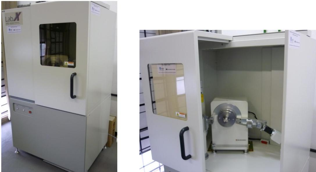
**Figura 3.6.** Difratorômetro de Raios X Shimadzu XRD 6000.
