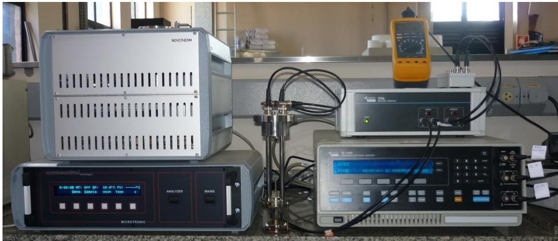
**Figura 3.12.** Forno Espectroscopia de Impedância Solartron 1260.
