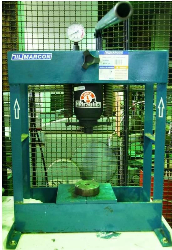
**Figura 3.9.** Prensa Hidráulica Marcon MPH-10.
