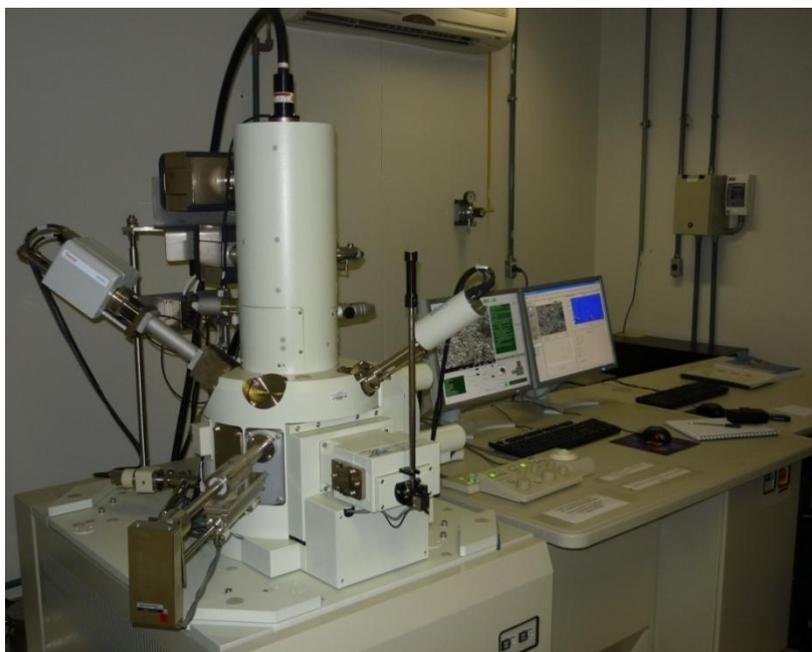
**Figura 3.11.** Microscópio de Varredura Eletrônica Jeol JSM-7001F.
