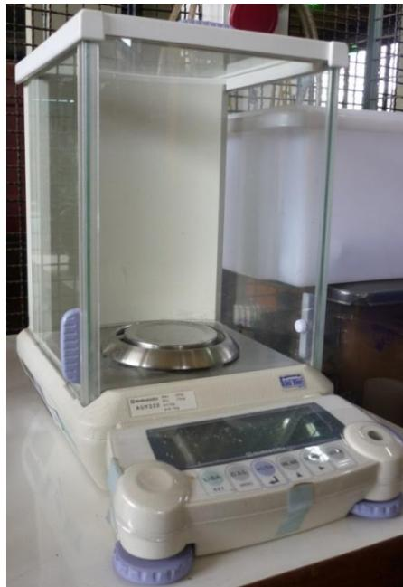
**Figura 3.10.** Balança de Precisão Shimadzu AUY-220.
