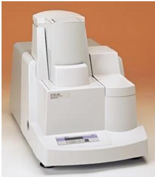
**Figura 3.5.** Equipamento para as Análises Térmica Diferencial e Termogravimétrica Shimadzu DTG-60H.
