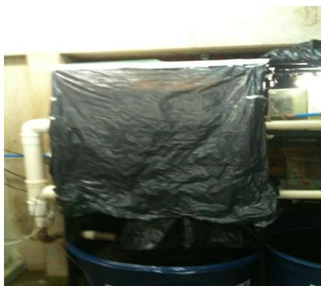
Figura 2. Aspecto do isolamento de luz dos tratamentos
