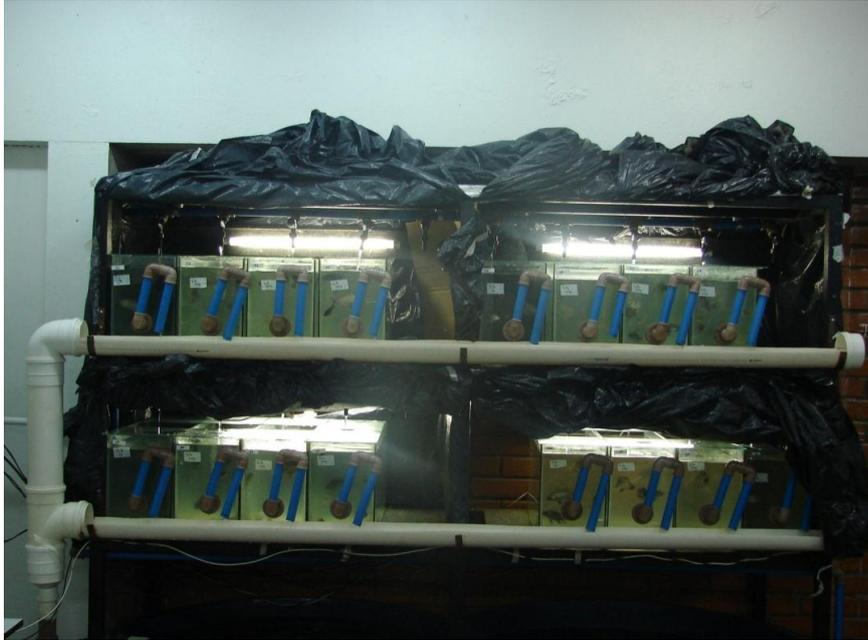
Figura 3. Aspecto das baterias de aquários abastecidos por sistema fechado de recirculação de água.
