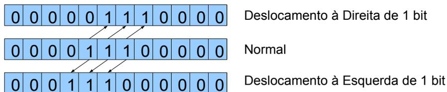
**Figura 4.7.** Exemplo de uma operação de deslocamento de *bit*
