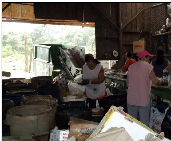
Figura 59: Esteira para facilitar a segregação dos resíduos. SCHLINDWEIN, J.R. 22/05/2012.
