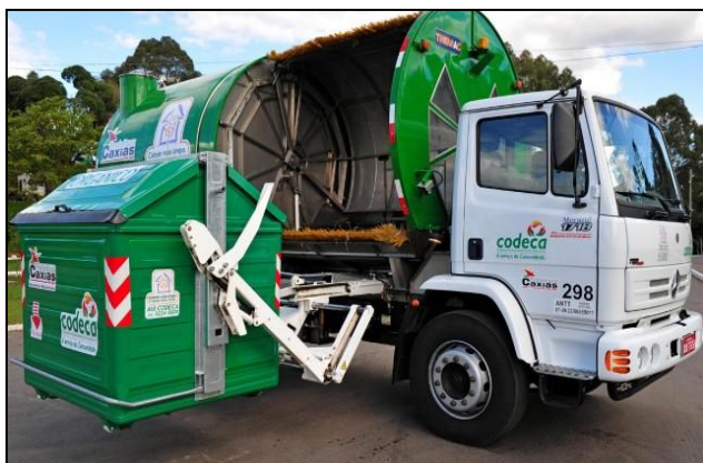
Figura 20: Caminhão que realiza a limpeza dos contêineres designados aos resíduos orgânicos. CODECA/2012.
