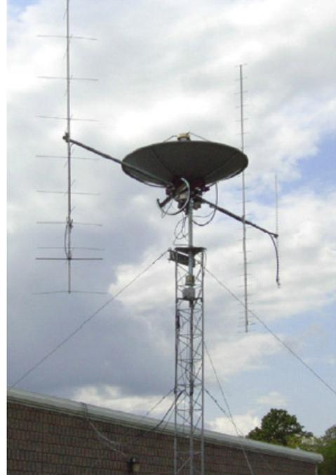
(b) Exemplo de antena parabólica em estação de solo para missão de nanosatélite, retirado de [5].
