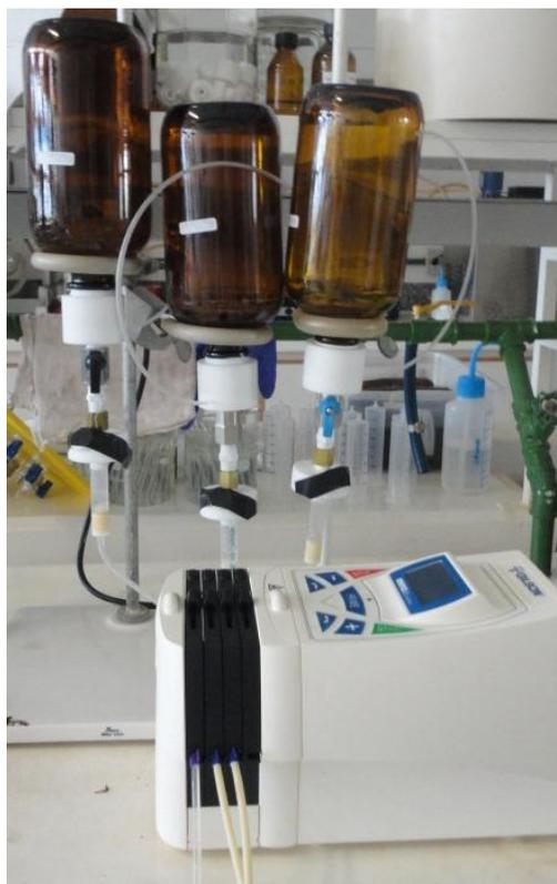
**Figura 14:** Sistema utilizado para a extração em fase sólida dos analitos nas amostras de água.
