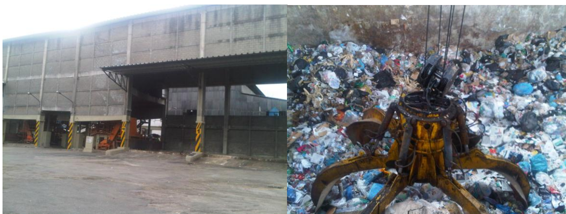
Figura 6.22 – Fachada frontal e pólo de alimentação da esteira transportadora da IRR do Caju Fotos: Kátia Campos Rio de Janeiro – 2012
