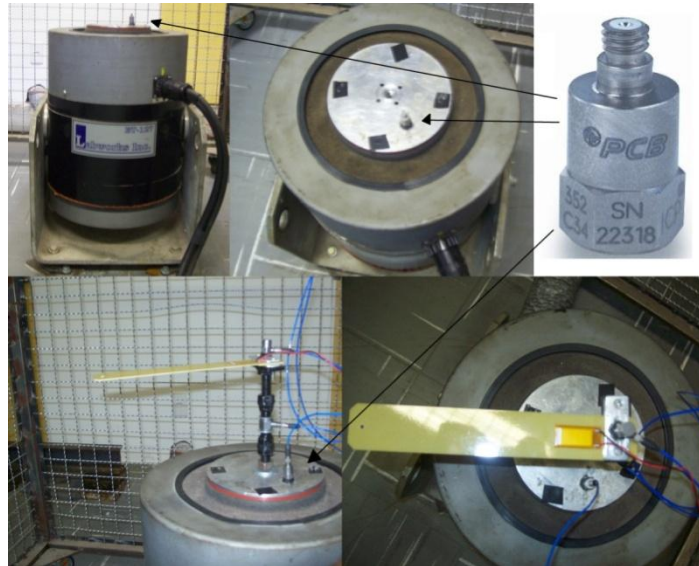
Figura 9 - Shaker modelo ET127 da Labworks, acelerômetro 352C34 e viga piezolétrica fixada através suporte metálico.
