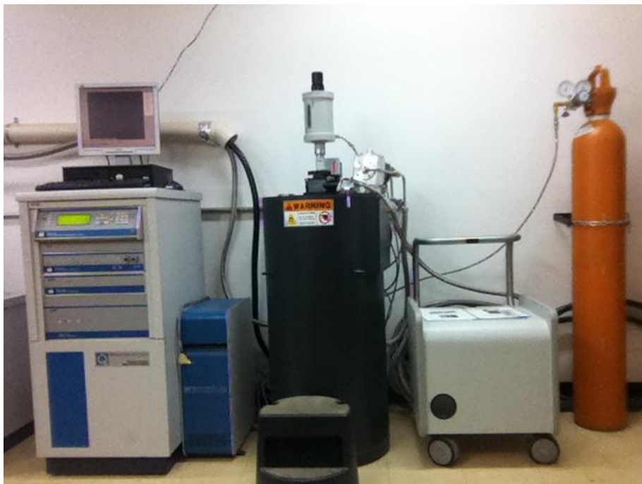
Figura 10: Aparelho PPMS multiusuário utilizado neste trabalho (juntamente com sua montagem), presente na Universidade de Brasília.
