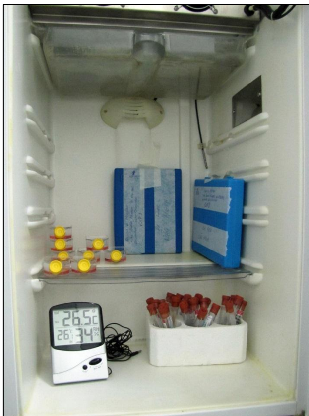
Figura 5. Câmara climatizada tipo B.O.D. (Tecnal – TE 382) contendo as caixas com lâminas em posição horizontal e vertical. Temperatura ajustada para 26 °C e humidade aferida com auxílio de termohigrômetro (Incoterm) durante o período experimental: 39±9 % U.R.
