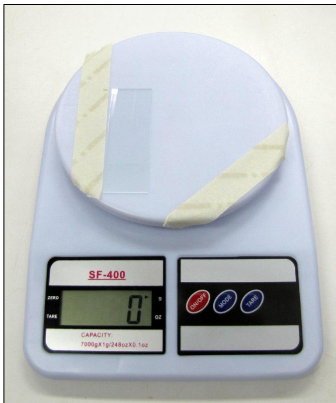
Figura 3. Balança de prato (SF-400®, Jiangsu, China) para aferição da pressão de aposição sobre lâmina de vidro.
