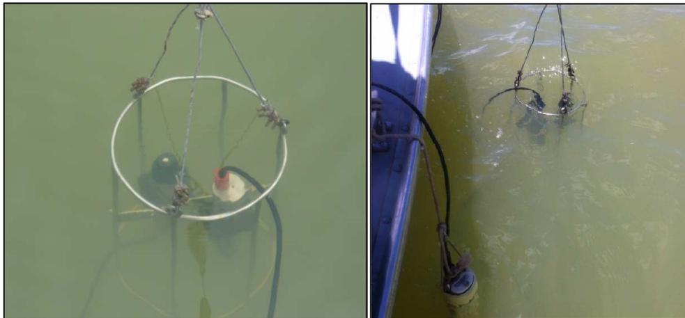
Figura 26 - Medição simultânea do Kd e sonda multiparâmetro de qualidade de água (turbidez)
