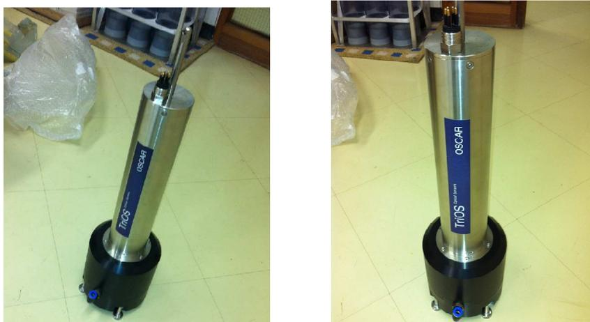
Figura 65 - Espectrorradiômetro OSCAR - TRIOS RAMSES
