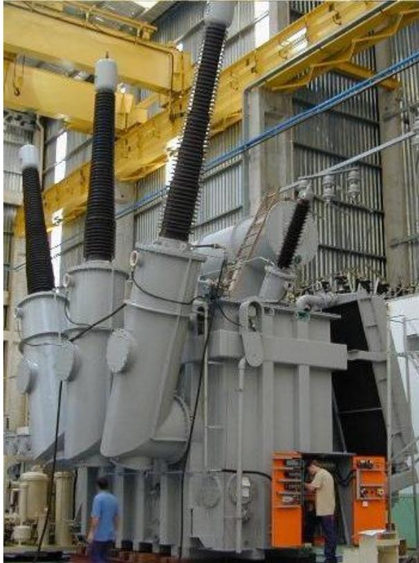
Figura 2. 4 - Autotransformado, fonte: Vasques (2011).
