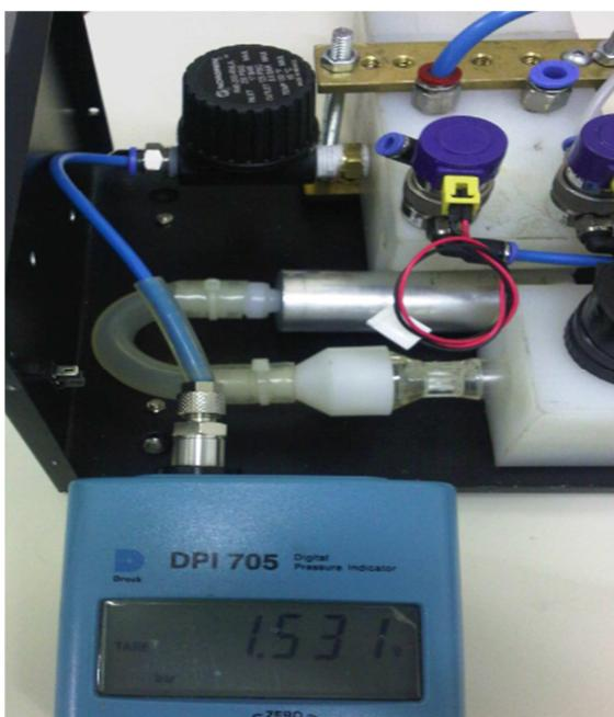
**Figura 44: Ajuste do regulador de pressão de oxigênio.**
