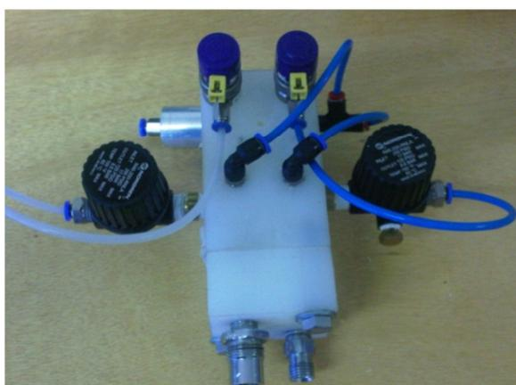
**Figura 81: Bloco de entrada montado com válvulas.**
