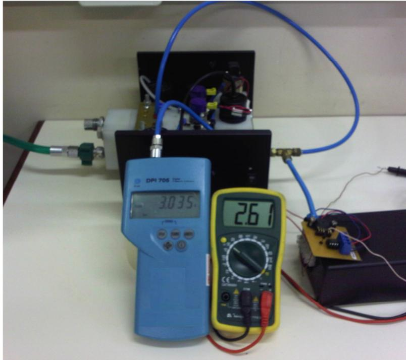
**Figura 62: Bancada de teste com pressão aplicada na entrada do sensor.**
