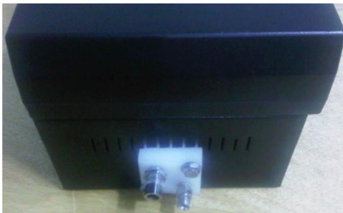
**Figura 84:** Vista Traseira do sistema pneumático visualizando bloco de entrada.
