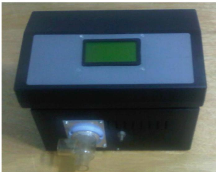
**Figura 85:** Módulo Neo-CPAP com *display* e válvula expiratória.
