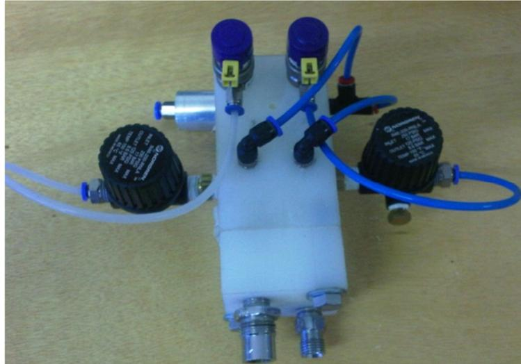
**Figura 29: Bloco de entrada e seus componentes.**
