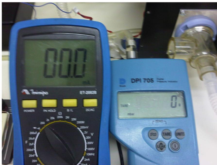
**Figura 49: Ajuste do zero da pressão da válvula expiratória.**
