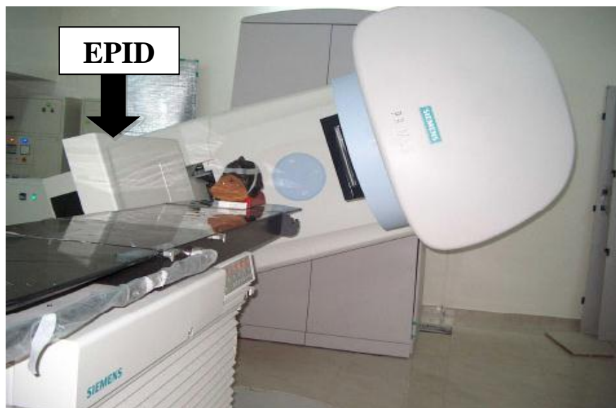
Figura 2 - Acelerador Linear Primus com Eletronic Portal Image Device (EPID) (Adaptado de RAVINDRAN, 2007).
