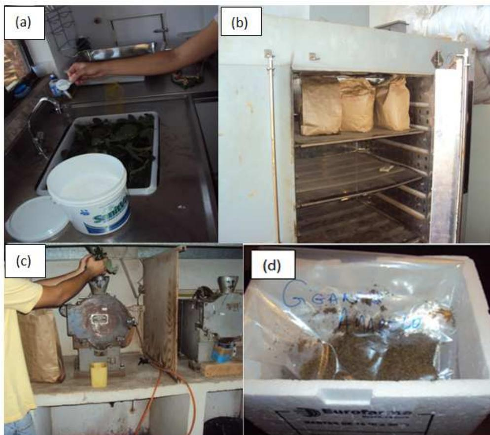
**Figura 6** Processamento das folhas de passiflora: (a) sanitização; (b) desidratação; (c) tamisação; (d) armazenamento
