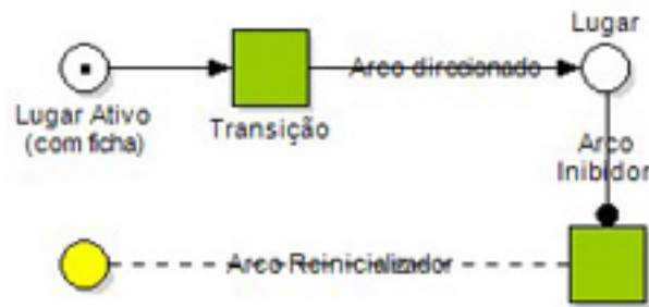
Figura 16: Elementos de uma Rede de Petri - Fonte: Produzido pelo autor
