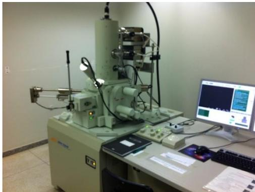
Figura 1.7 - Microscópio de Varredura Eletrônica JSM-7001F.
