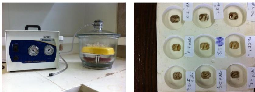
Figuras 1.3 e 1.4 – Bomba a vácuo e forma de silicone com o material vegetal emblocado em historesina.
