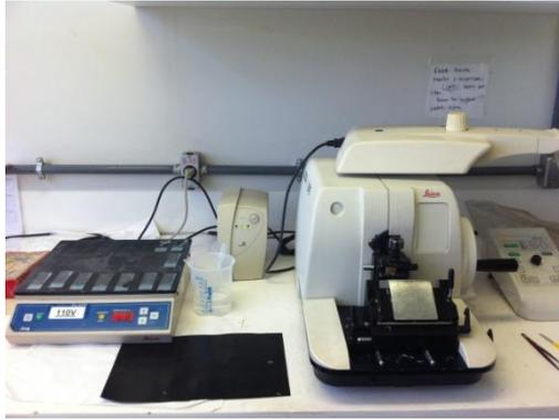
Figura 1.5- Micrótopo rotativo e placa aquecedora.
