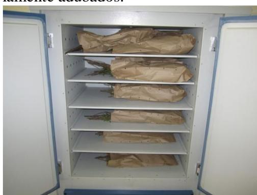
Figura 2.5: Estufa de ar circulante com o material vegetal acondicionado em sacos de papel furados para permitir correta secagem.
