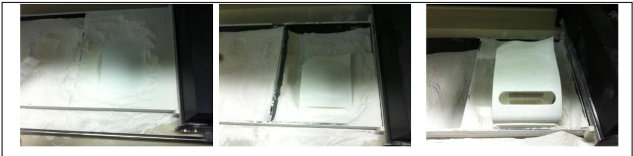
Figura 37 - Fotos do processo de limpeza do protótipo na impressora Zprinter
