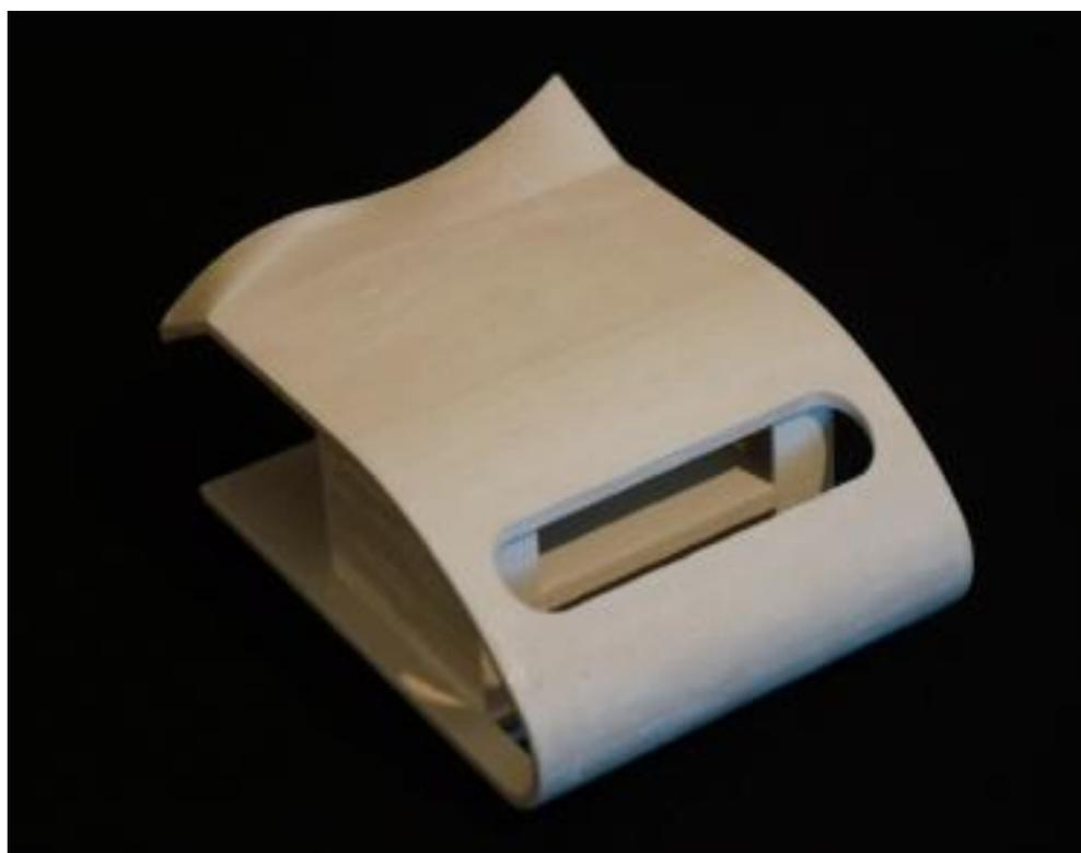
VISTA SUDOESTE – FOTO PROTÓTIPO AZ (REVIT > ZPRINTER)
