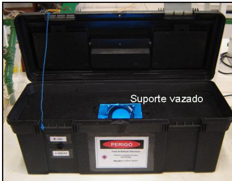
Figura 5- Fotografia da expositora com detalhe do suporte vazado.
