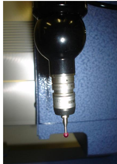
FIGURA 3.5 Apalpador comutado ou de gatilhamento - MMC Cantilever.
