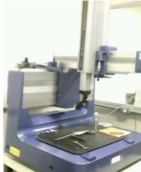
FIGURA 3.4 MMC Cantilever modelo QM-353 fabricante MITUTOYO
