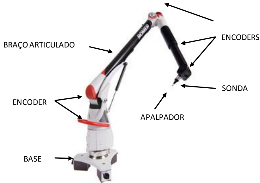
FIGURA 2.2 Braço articulado Romer multi-gage (Romer,2009).
