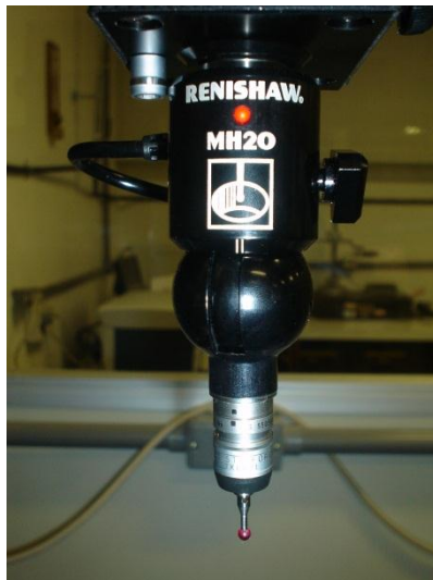
FIGURA 3.5 Apalpador comutado ou de gatilhamento - MMC Cantilever.
