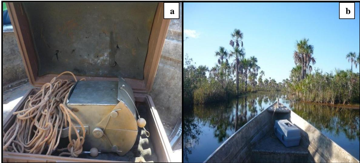
Fig. 14: Equipamentos utilizados em campo. a) draga de Eckman b) barco utilizado para coleta em trechos da bacia do rio das Pacas sem acesso adequado por estrada.
