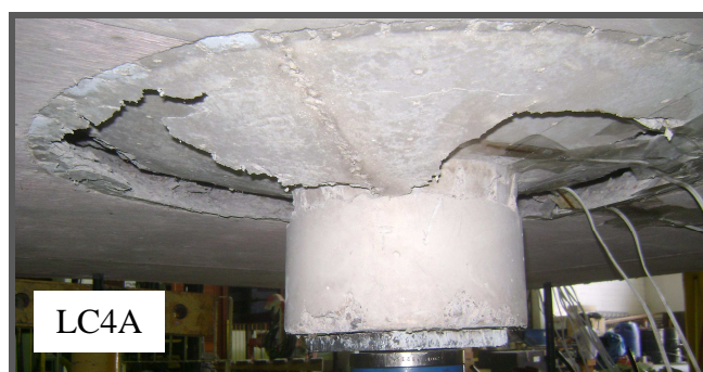
Figura A.2 – Ruptura interna na laje L4A.
