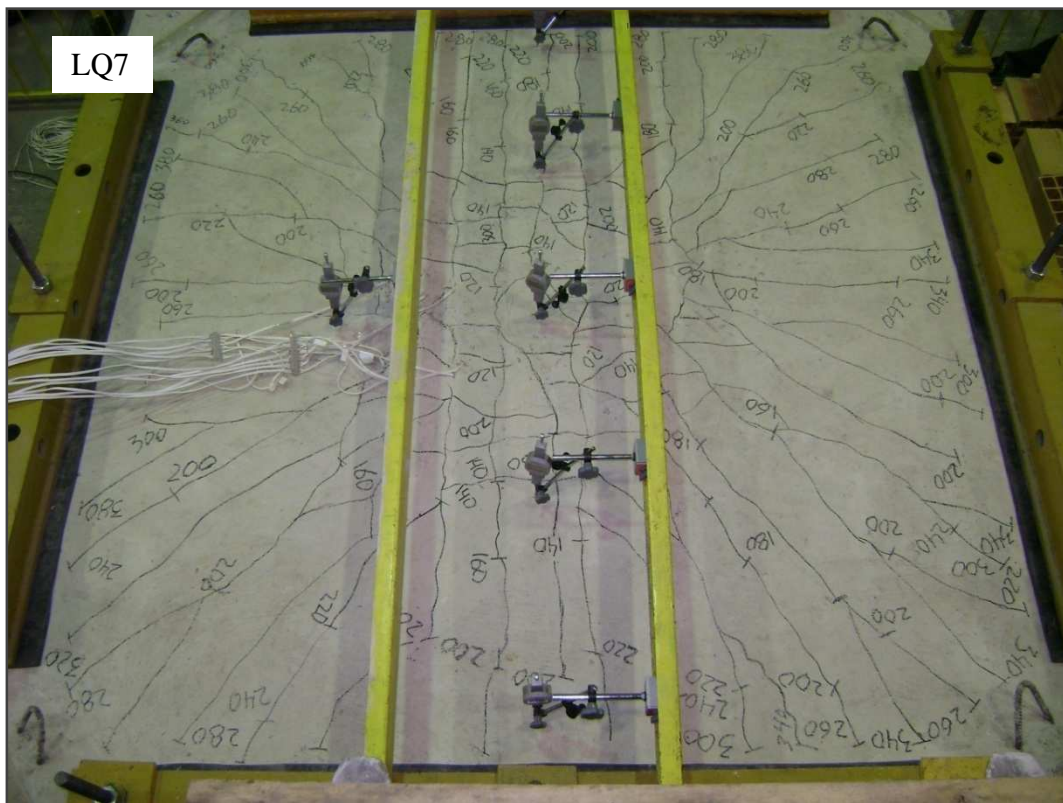
Figura 4.27 - Fissuras da laje LQ6 (com capitel quadrado e relação h_H/l_H de 1:2) e LQ7 (com capitel quadrado e relação h_H/l_H de 1:3)
