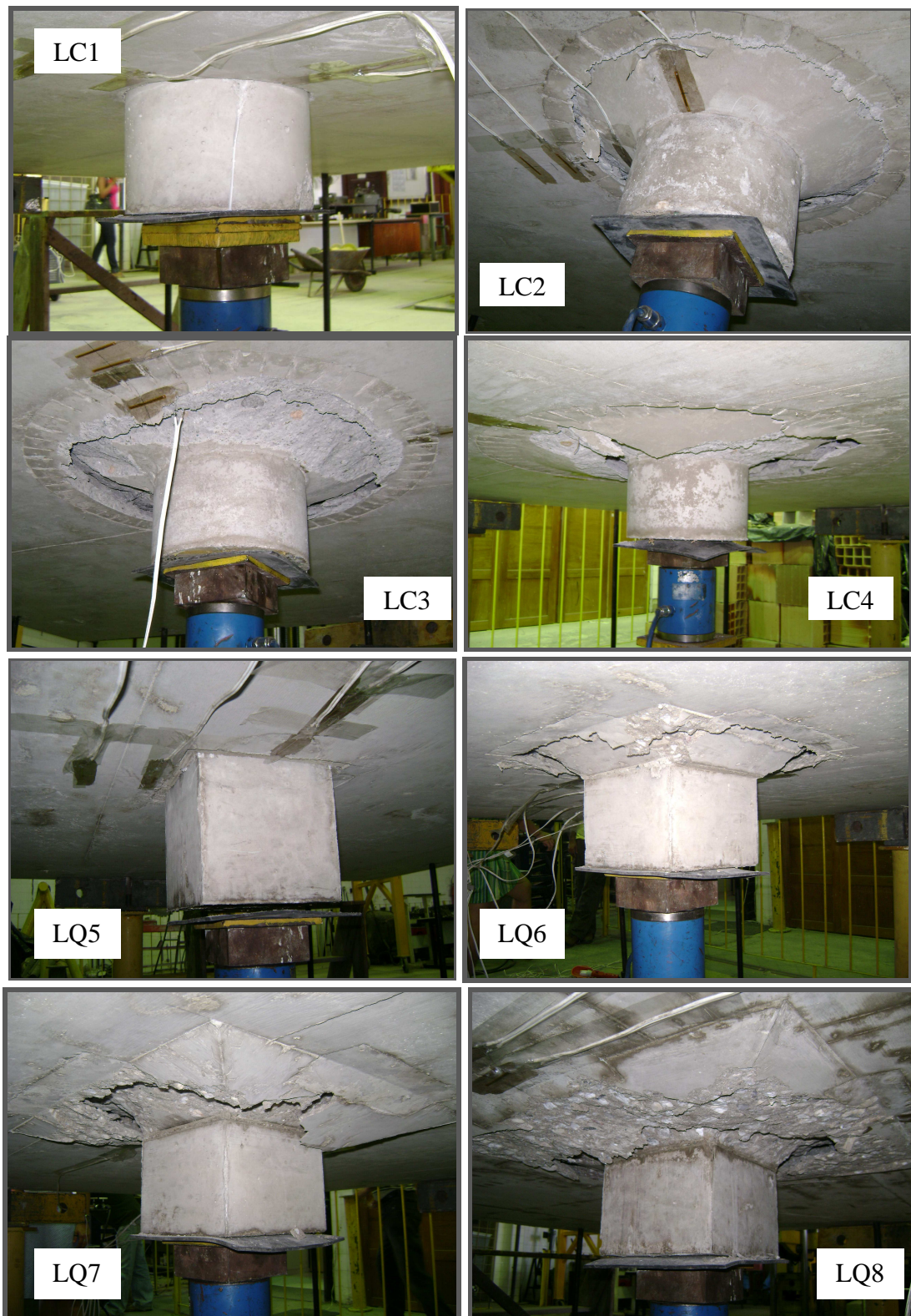
Figura 6.2 – Local de ruptura das lajes da 1ª e 2ª séries
