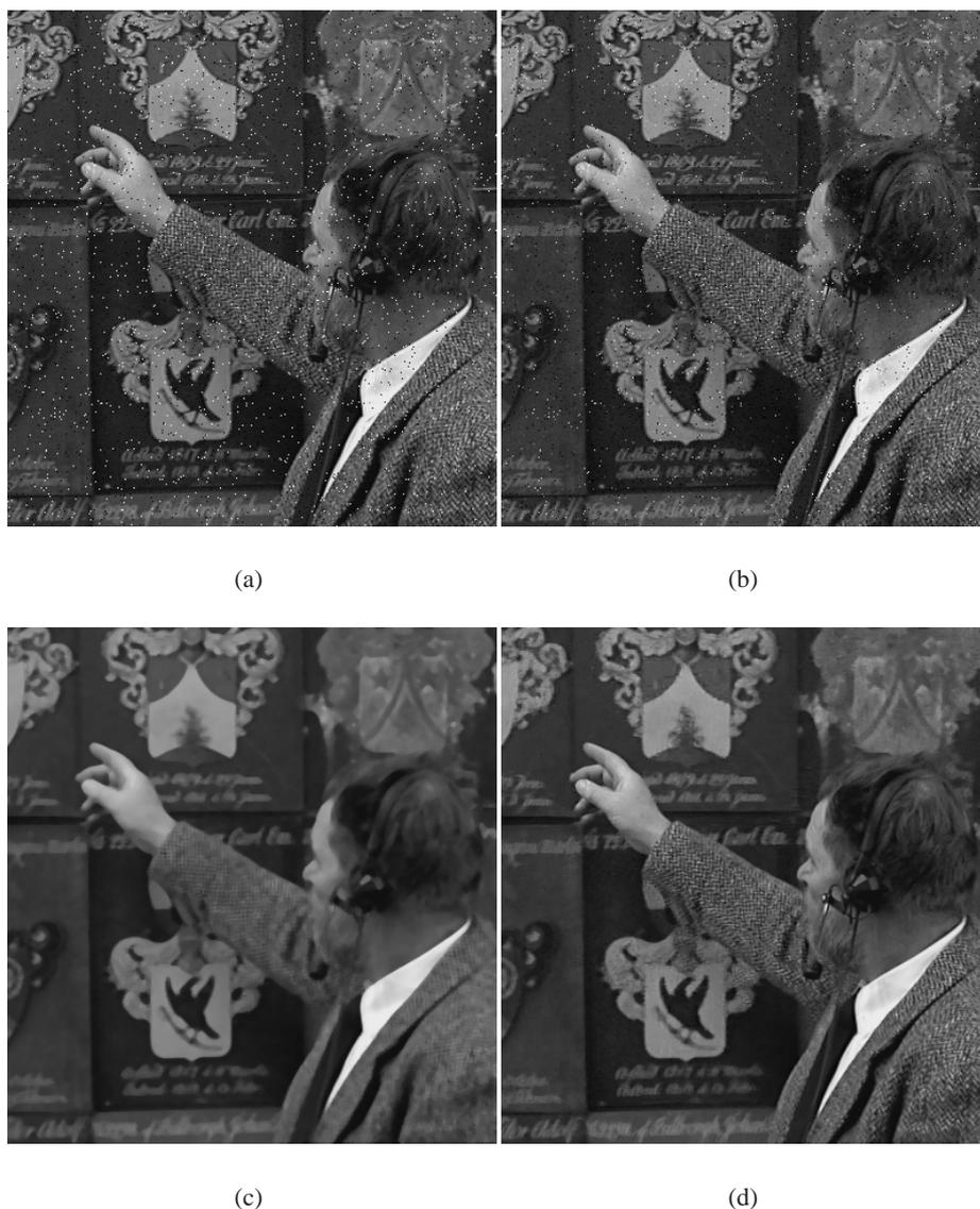
Figura 5.11: Região do 16º quadro da sequência *Shields*: (a) com ruído ‘*salt and pepper*’, (b) realçado utilizando exemplos com ruído ‘*salt and pepper*’, (c) com um filtro da mediana aplicado ao ruído ‘*salt and pepper*’, (d) realçada utilizando o filtro da mediana.
