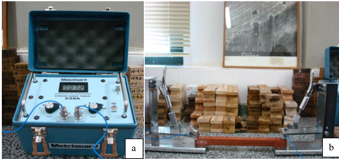
Figura 4.6 - Ensaio de ondas de tensão: a) Equipamento Stress Wave Timer 239A (Metriguard Inc.); b) Amostra submetida ao ensaio.
