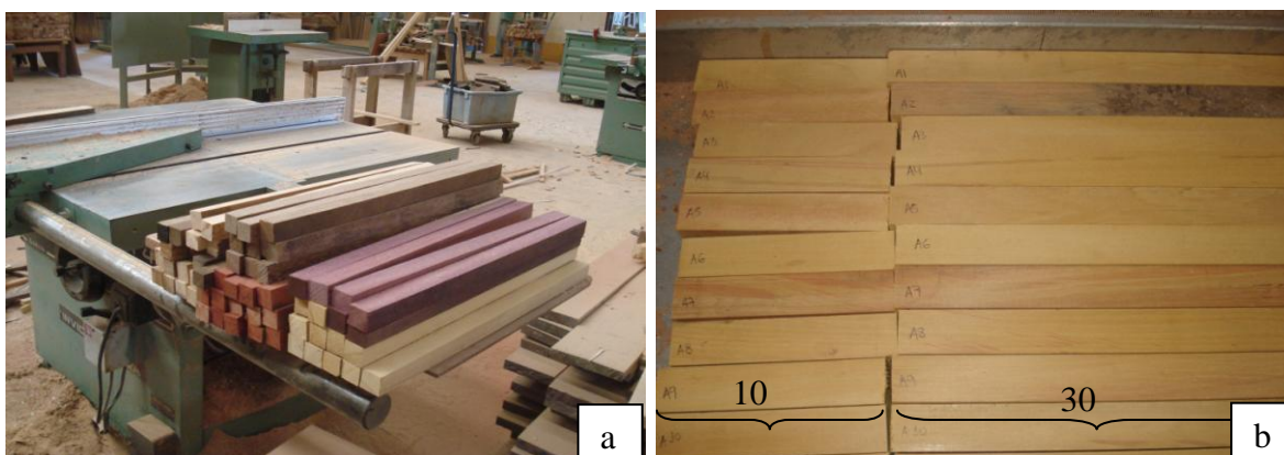
Figura 4.2 - Preparação das amostras para caracterização tecnológica da madeira: a) amostras das espécies estudadas; b) Retirada das sub-amostras para execução dos ensaios.
