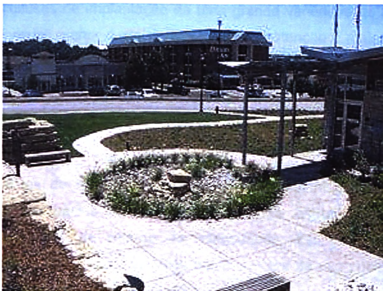
Foto 3.2: Jardim de chuva, modelo de biorretenção (KANSAS, N/D).
