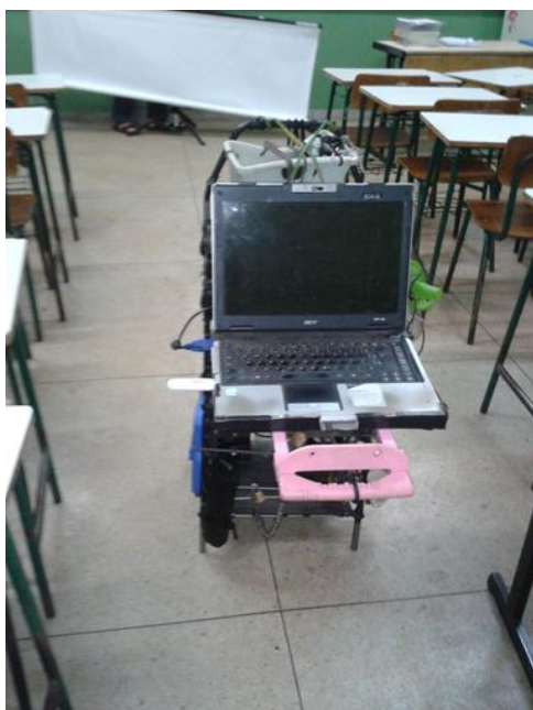
Imagem 2 - Carrinho completo (notebook, data-show, som e baterias) para aulas com as NTICE, com acesso à internet (modem e equipamentos de propriedade do próprio professor, transportado todos os dias em seu carro pois trabalha em duas escolas).
